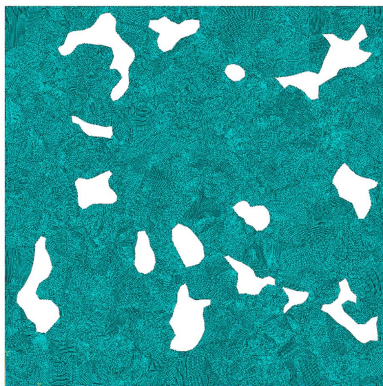
Slika 5.9 Mreža od 101233 konačna elementa heterogenog modela 200x
