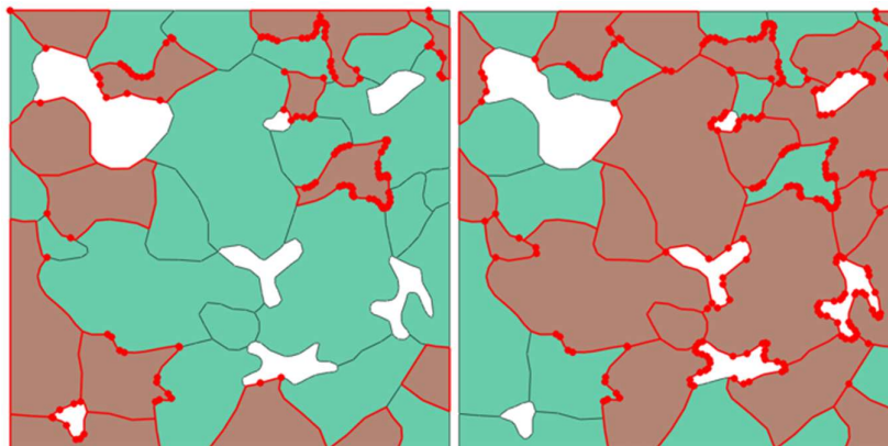
Slika 5.19 Dodjeljivanje materijalnih svojstava različitim zrnima (lijevo bainit, desno ferit) heterogenog modela 500x
