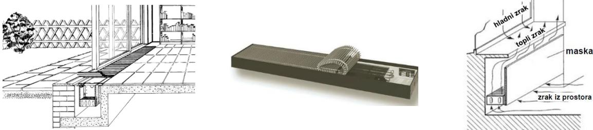
Slika 4.1. Podni konvektori (lijevo i sredina), zidni konvektor (desno) <sup>[1]</sup>
