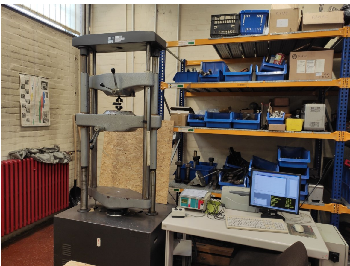
Slika 38. Kidalica u Laboratoriju za ispitivanje mehaničkih svojstava, FSB
