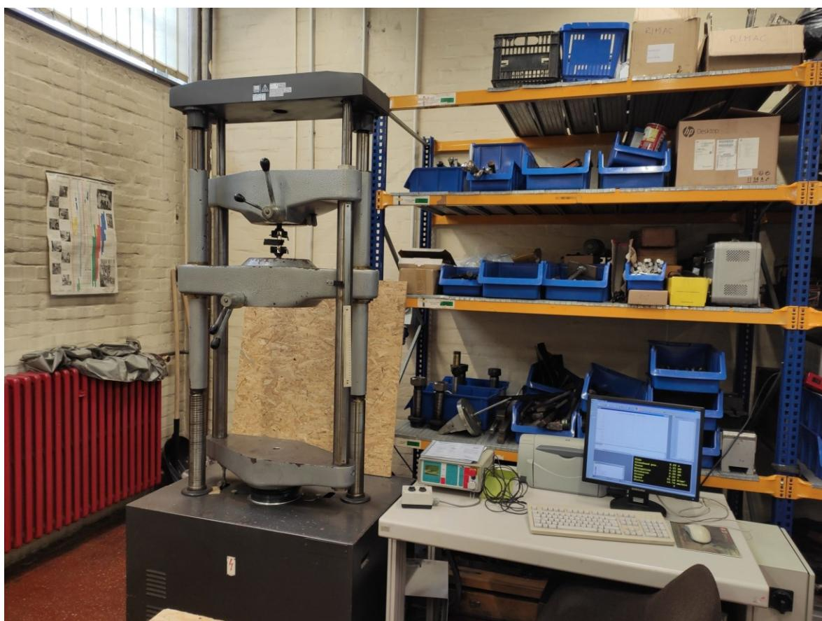
**Slika 38. Kidalica u Laboratoriju za ispitivanje mehaničkih svojstava, FSB**
