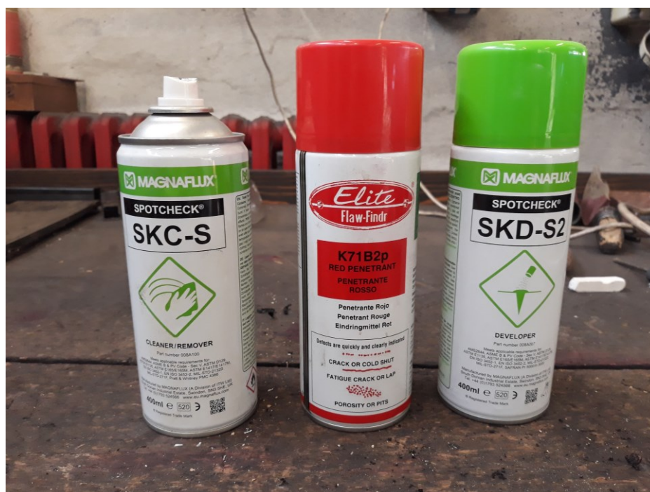
Slika 48. Sredstvo za čišćenje proizvođača Magnaflux, penetrant proizvođača NDT Italiana i razvijajući proizvođača Magnaflux
