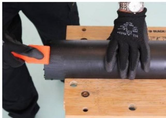
Slika 26. Struganje površine cijevi [20]
