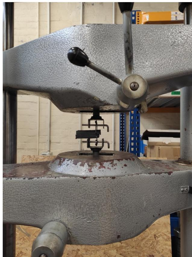
**Slika 39. Uzorak postavljen u kidalicu**
