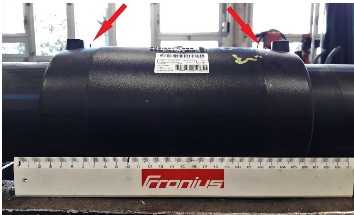
Slika 31. Elektrofuzijska spojnica na Cijevi 1
