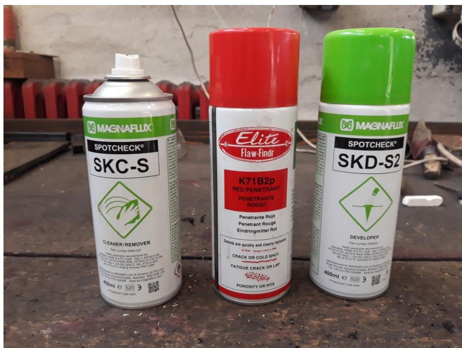
**Slika 48.** Sredstvo za čišćenje proizvođača Magnaflux, penetrant proizvođača NDT Italiana i razvijač proizvođača Magnaflux
