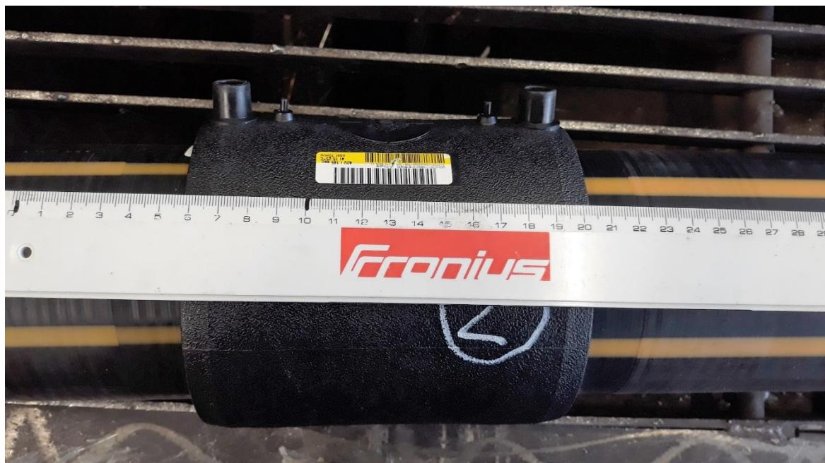
**Slika 32. Elektrofuzijska spojница na Cijevi 2**
