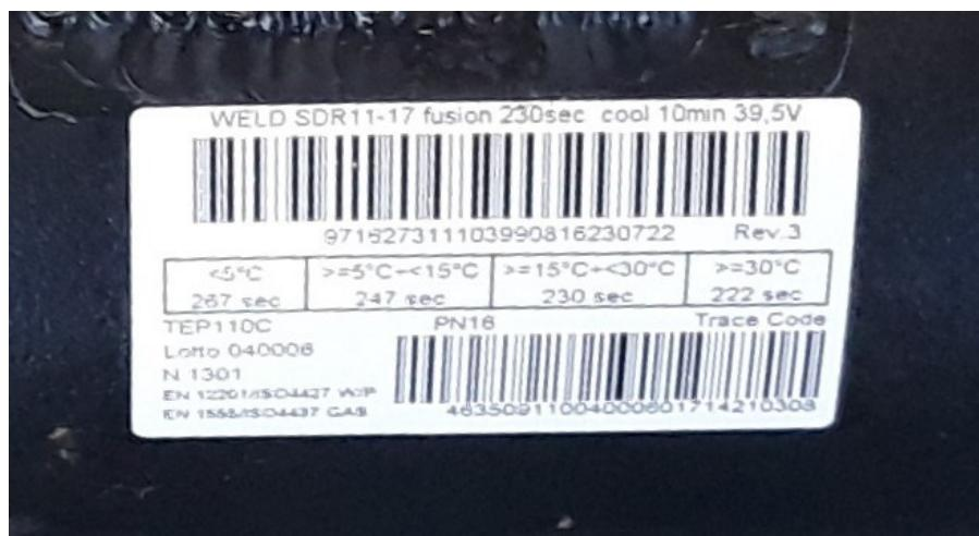
**Slika 25. Etiketa i bar kod na elektrofuzijskoj spojnici**
