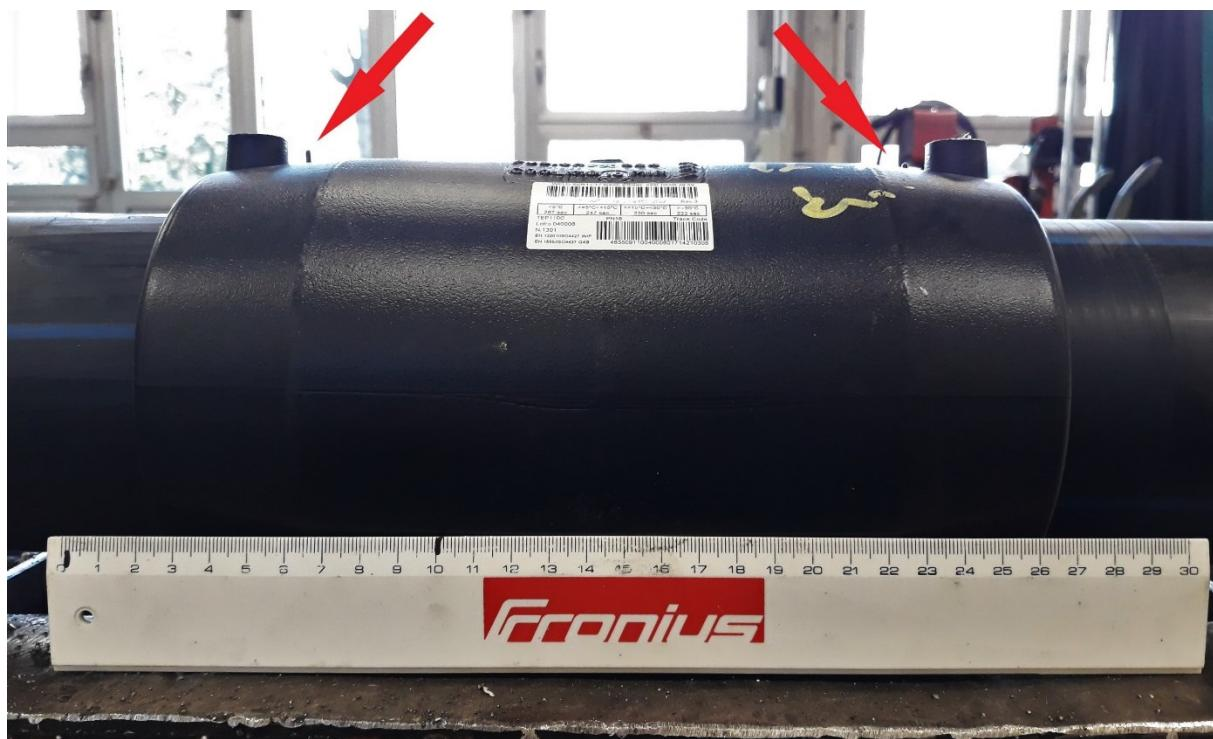
**Slika 31. Elektrofuzijska spojница na Cijevi 1**
