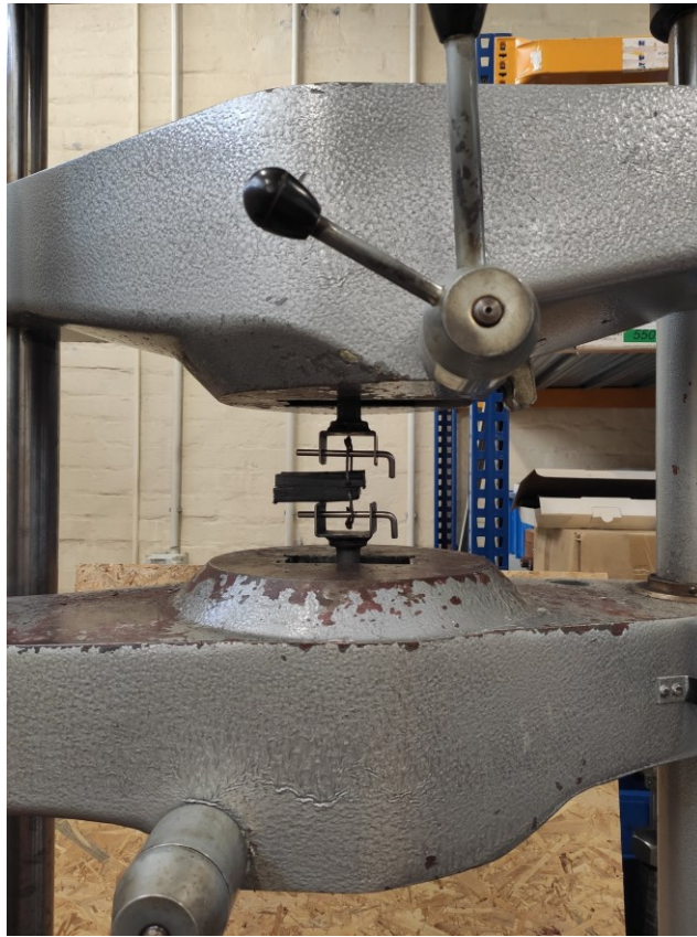
Slika 39. Uzorak postavljen u kidalicu
