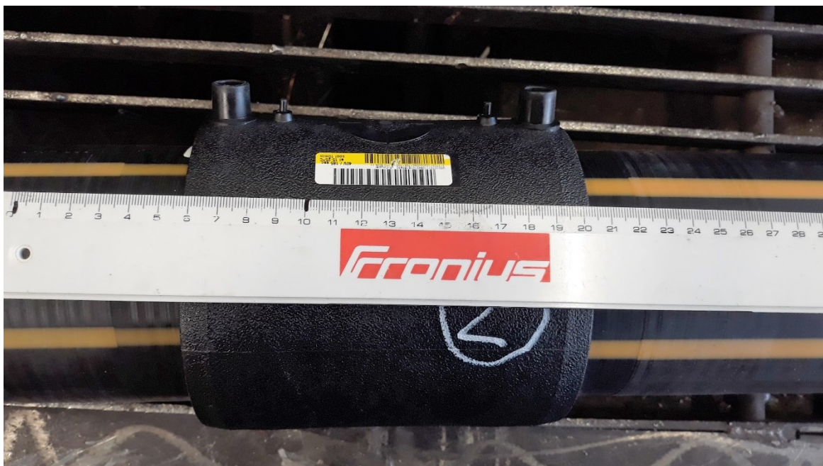
Slika 32. Elektrofuzijska spojnica na Cijevi 2
