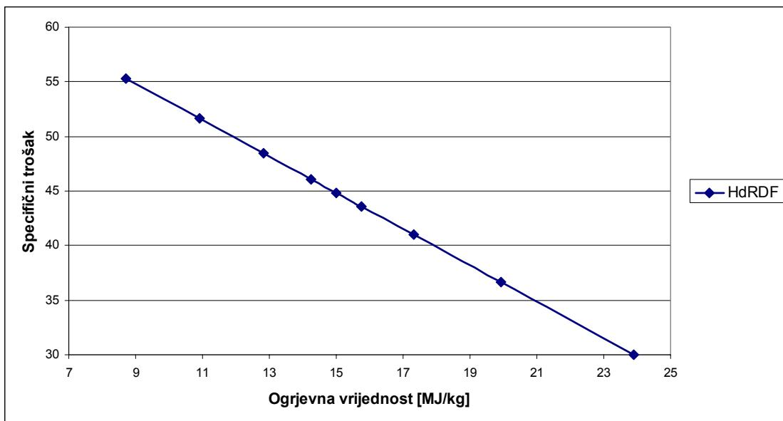
Slika 5.4. Analiza osjetljivosti utjecaja ogrjevne vrijednosti RDF-a.
