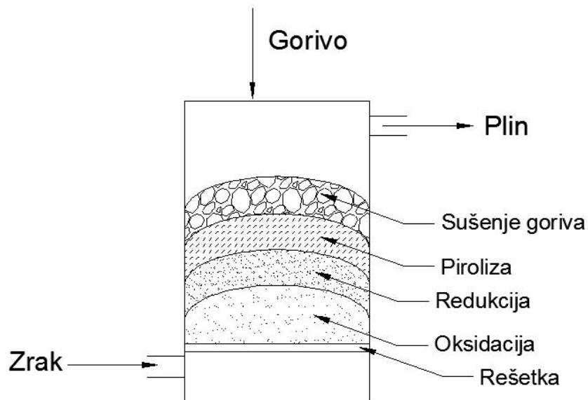
Slika 4.3. Protusmjerni rasplinjač [8]
