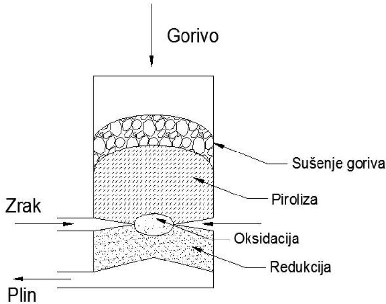
Slika 4.2. Istosmjerni rasplinjač [8]
