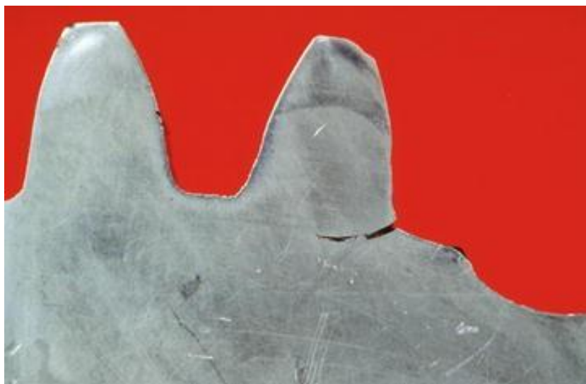
Slika 3. Lom zuba uslijed savojnog opterećenja [3]
