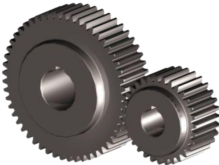
Slika 1. Zupčani par s ravnim zubima [1]
