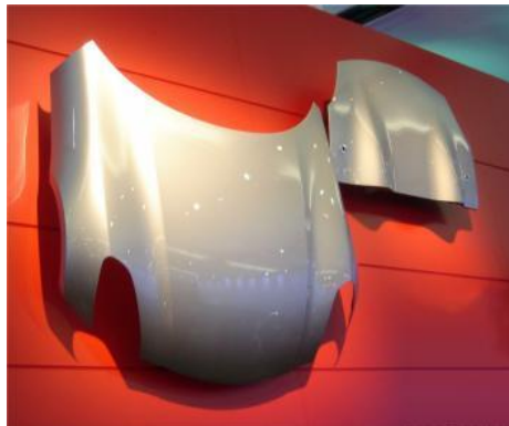
Slika 3.16. Hydrooblikovan prednji i zadnji poklopac karoserije [18]
