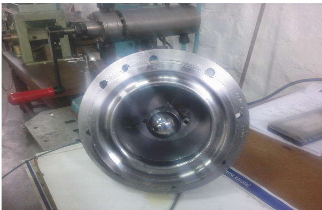
Slika 6.4. Sfera koja sprečava slobodno oblikovanje lima
