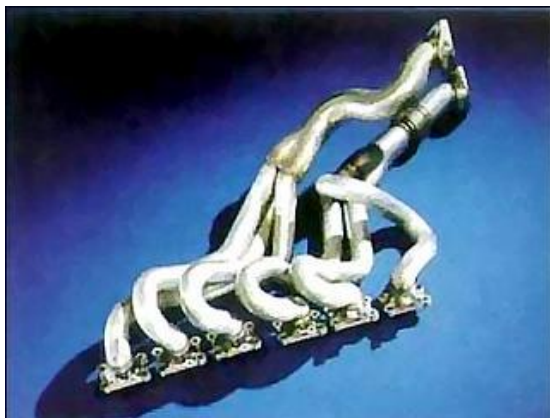
Slika 3.15. Hidrooblikovana ispušna grana 6 cilindarskog motora [18]
