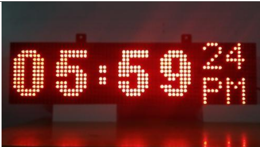
Slika 2. Realizacija LED sata korištenjem matričnog prikaznika [9]
