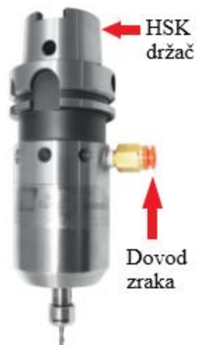
Slika 2.10 Vreteno zračne turbine [21]
