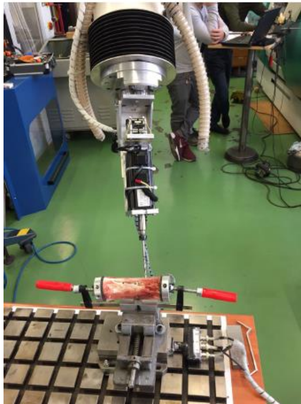
Slika 1.4 Ispitivanje sustava bušenjem koštanog tkiva [5]
