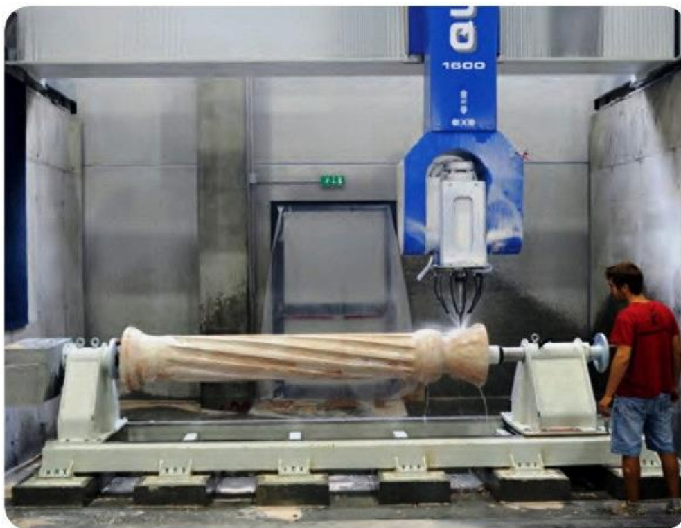
Slika 11. Okretno glodanje kamena [15]
