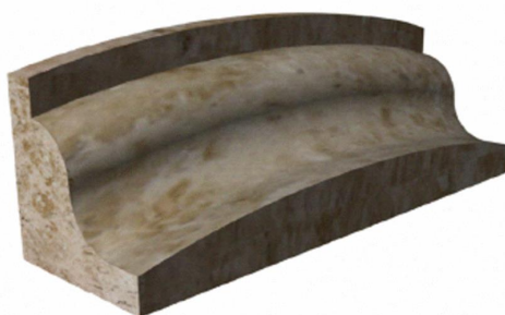
Slika 8. Primjer izratka obrađenog na troosnom CNC stroju [12]
