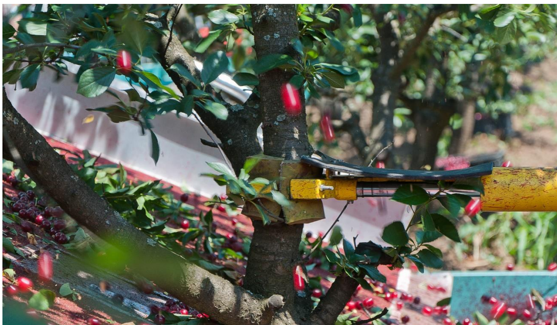
Slika 2. Strojna berba trešenjem stabla
