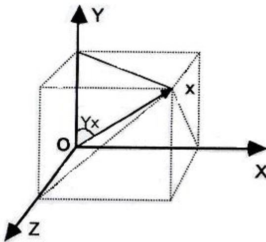
**Slika 18. Komponente jediničnog vektora x u globalnom referentnom**
