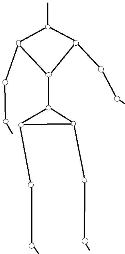
Slika 7. Kinematička shema biomehaničkog modela – žičani model
