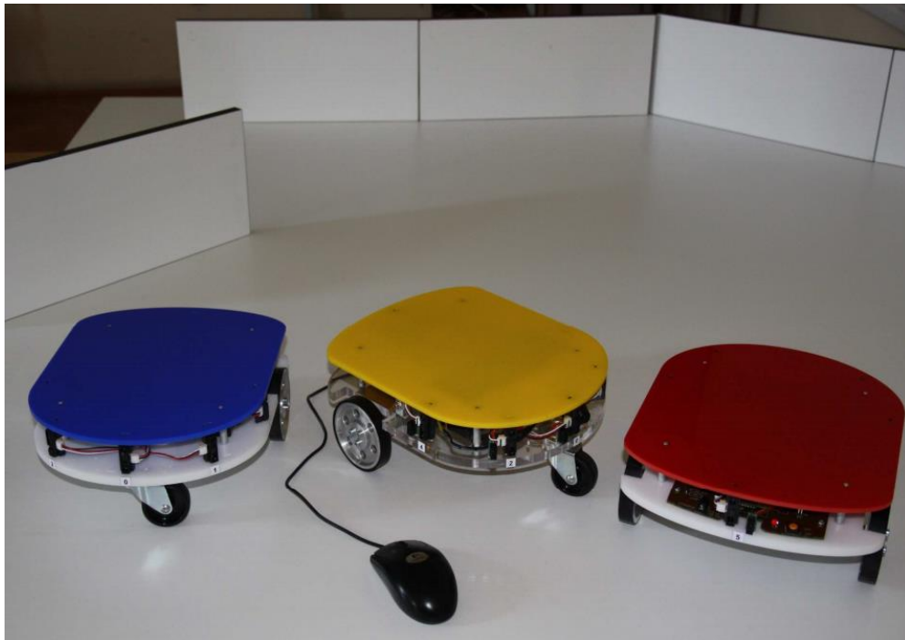
Slika 1: Mobilni robot FSB-a eMIR
