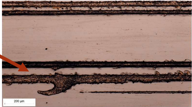
Slika 10.14. Alatni čelik K390 MC oznake C2 (TiN/TiCN prevlaka) na povećanju 100 puta
