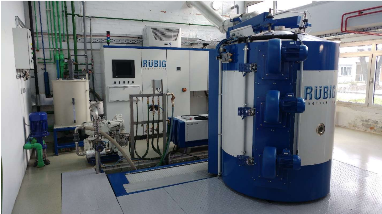
Slika 8.2 Industrijska vakuumska peć Rübige GmbH type PC 70/90 [5]
