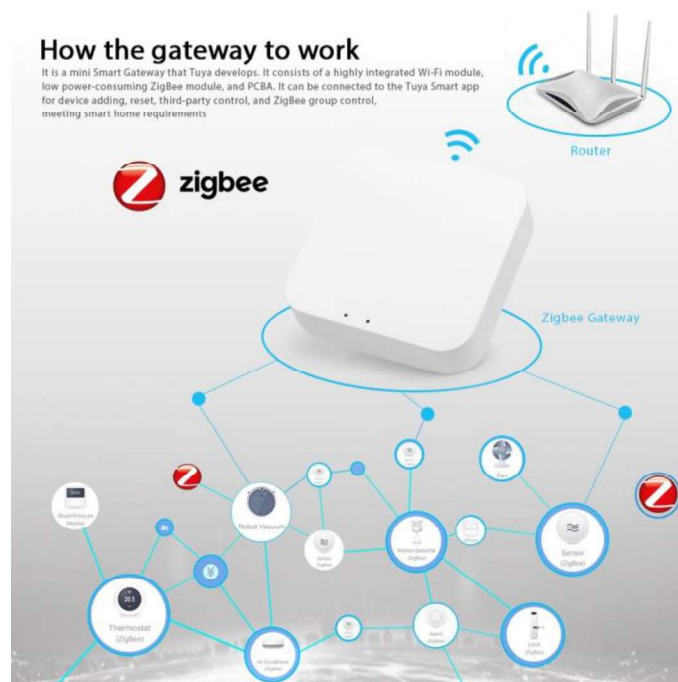
Slika 2: Prikaz komunikacije preko ZigBee protokola
