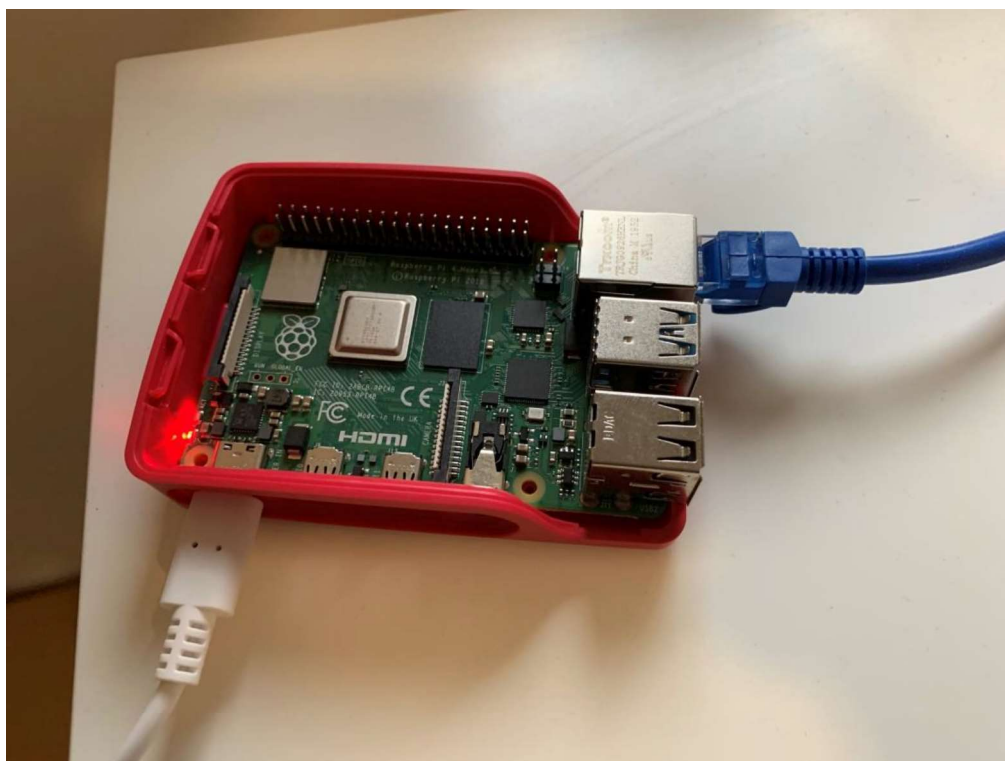
Slika 13: Raspberry Pi 4 s kučičem i spojen za Home Assistant
