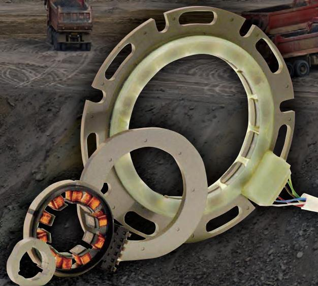
**Singlsyn** は、ロータにコイルをなくしたことにより、ローコスト化、高信頼性を実現したVR形レゾルバです。ロータ鉄芯を特殊な形状にし、ロータ鉄芯とステータ鉄芯間のギャップの変化により、出力電圧の振幅変化を発生させています。ビルトインタイプの超薄型構造のため、組込みスペースの最小化を可能にしました。
