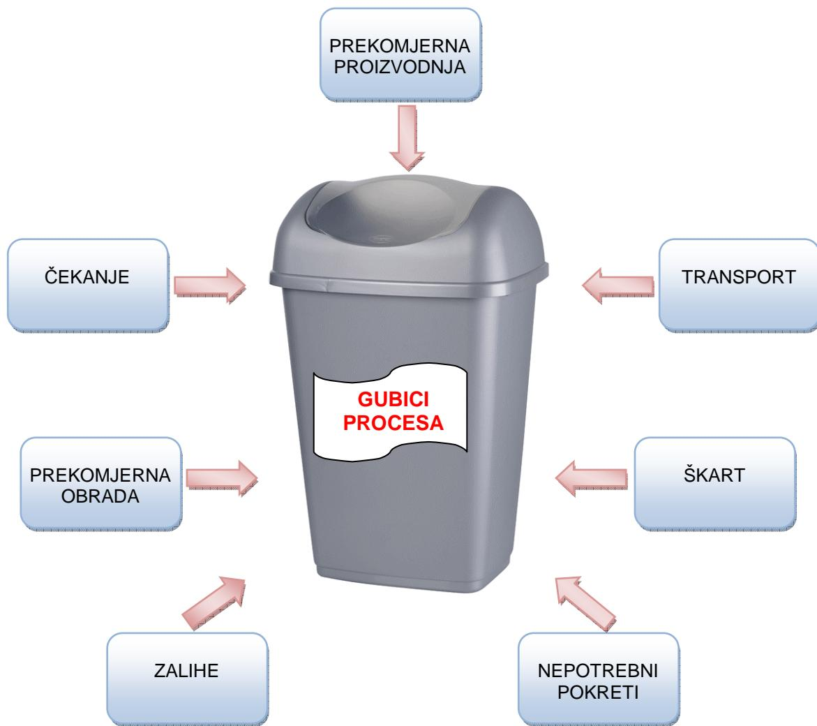
**Slika 16.** Prikaz gubitaka/rasipanja u procesu proizvodnje
