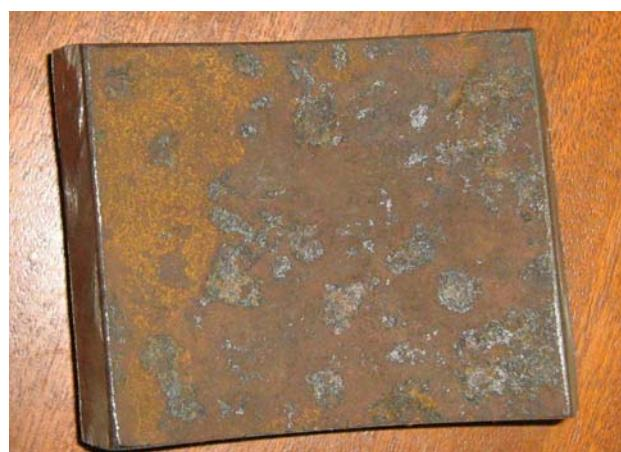
Slika 5.1 Reprezentativni uzorak cjevovoda za izradu epruveta
