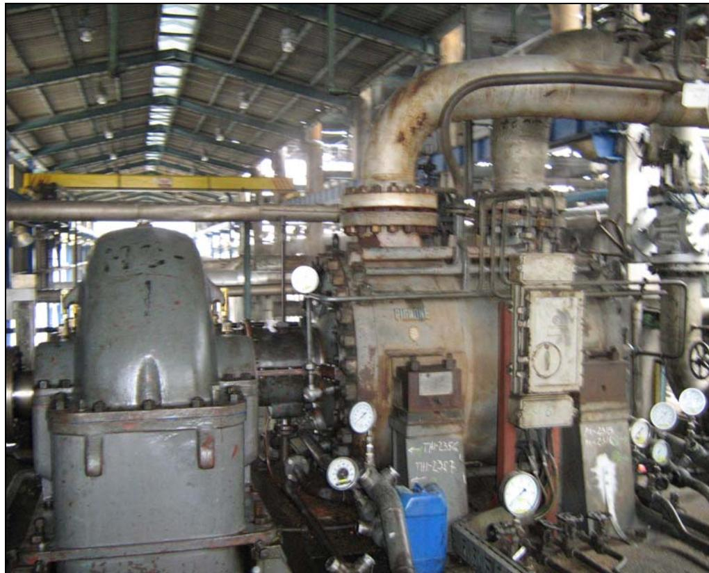
Slika 4.3 Centrifugalni kompresor za transport vodika 301-MC-1 [8]
