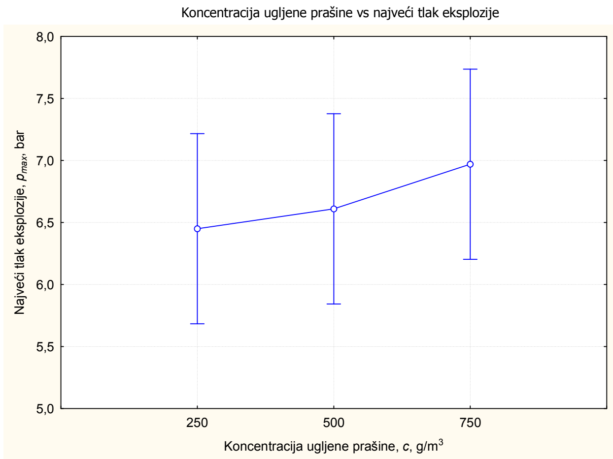
Slika 5.36 Prikaz utjecaja koncentracije prašine na tlak eksplozije
