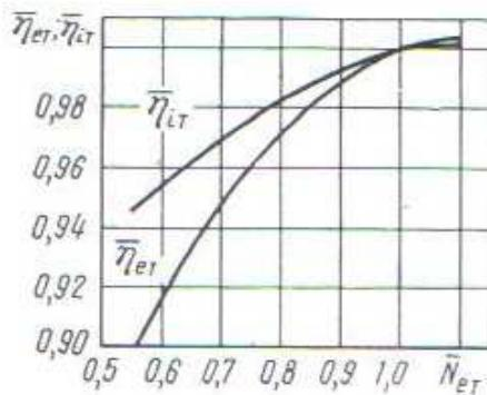
Slika 18. Eksperimentalne zavisnosti unutarnje i efektivne iskoristivosti
