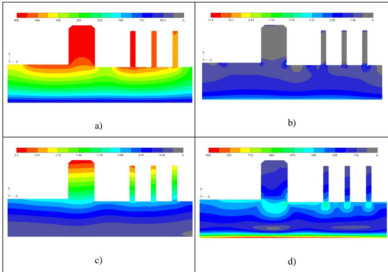
**Slika 50.** Detalj rotora; a)Temperaturno polje ( $^{\circ}\text{C}$ ), b)Ukupni temperaturni gradijent, c)Radijalna deformacija (mm) usljed temperaturnog polja i vrtnje, d)HMH naprezanja ( $\text{N/mm}^2$ ) usljed temperaturnog polja i vrtnje
