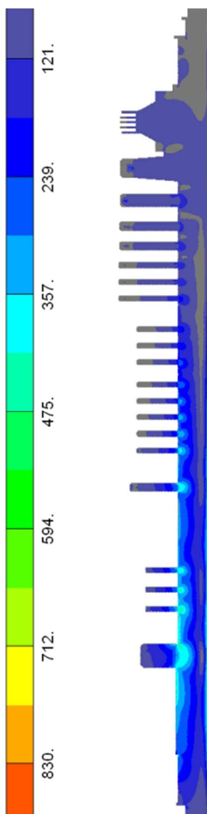
Slika 49. HMH naprezanja ( $\text{N/mm}^2$ ) uslijed temperaturnog polja i vrtnje
