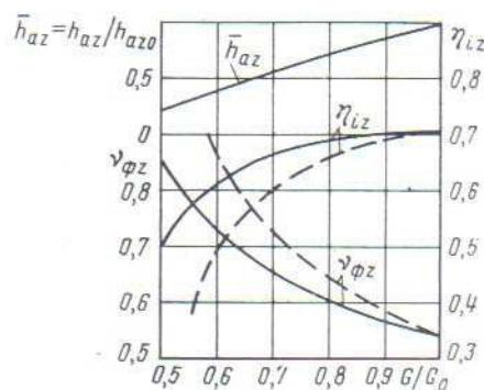
**Slika 16. Promjena entalpijskog pada, karakteristike  $V_{srR0} = u / c_{F0}$  i unutarnje iskoristivosti posljednjeg stupnja na promjenjivim režimima kod regulacije grupama sapnica**
