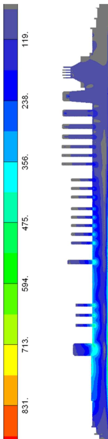
Slika 41. HMH naprezanja ( $\text{N/mm}^2$ ) uslijed temperaturnog polja i vrtnje
