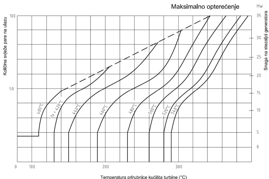
**Slika 5. Dijagram zavisnosti dozvoljenog opterećivanja o temperaturi prirubnice kućišta i temperaturi svježe pare ( $t_0$ - temperatura svježe pare), [6]**
