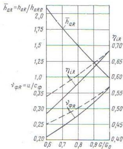
**Slika 14. Promjena entalpijskog pada, karakteristike  $\nu_{srR0} = u / c_{F0}$  i unutarnje iskoristivosti regulacijskog stupnja na promjenjivim režimima kod regulacije grupama sapnica**
