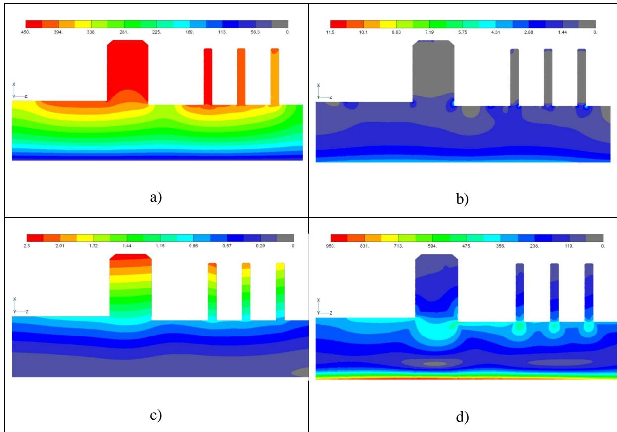
**Slika 46.** Detalj rotora; a)Temperaturno polje ( $^{\circ}\text{C}$ ), b)Ukupni temperaturni gradijent, c)Radijalna deformacija (mm) uslijed temperaturnog polja i vrtnje, d)HMH naprezanja ( $\text{N/mm}^2$ ) uslijed temperaturnog polja i vrtnje
