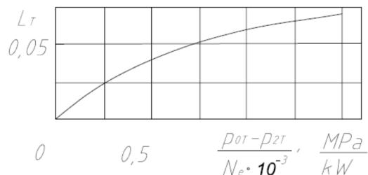
Slika 19. Faktor praznog hoda jednokućišne turbine
