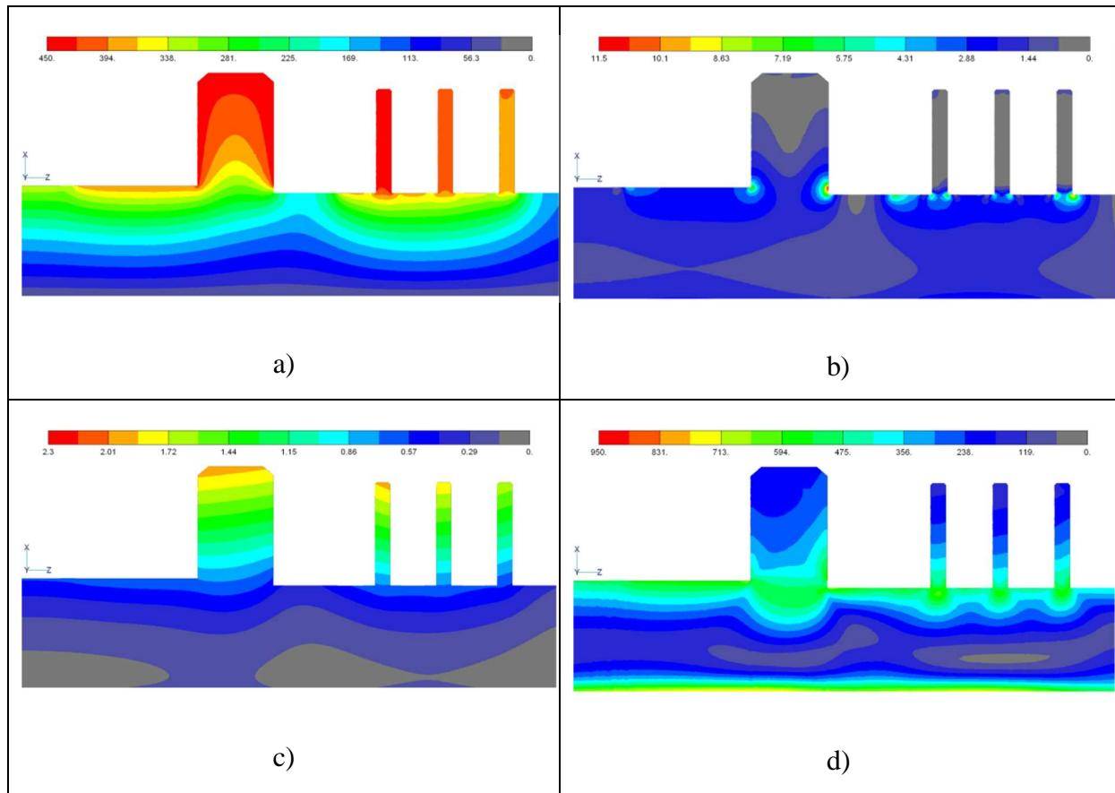
**Slika 38.** Detalj rotora; a)Temperaturno polje ( $^{\circ}\text{C}$ ), b)Ukupni temperaturni gradijent, c)Radijjalna deformacija (mm) usljeđ temperature i vrtnje, d)HMH naprezanja (N/mm $^2$ ) usljeđ temperature i vrtnje
