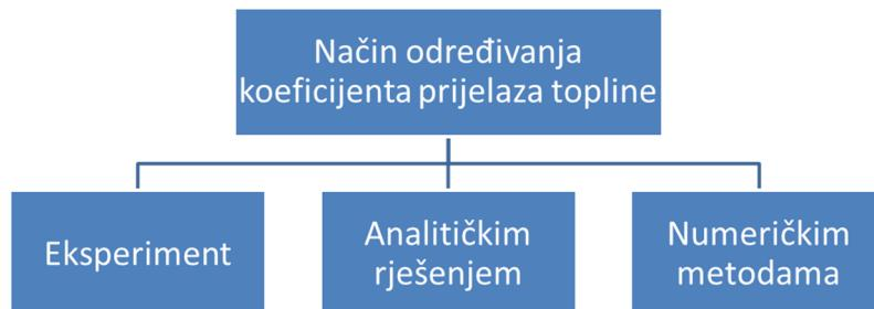
**Slika 24. Načini određivanja koeficijenata konvektivnog prijelaza topline**
