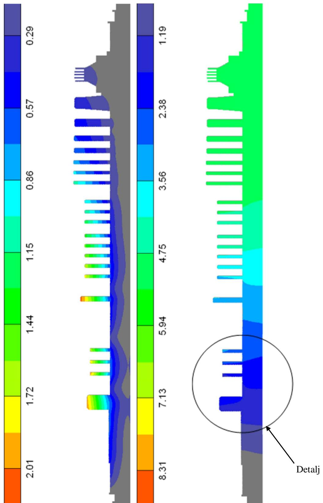
Slika 36. Radijalna i aksijalna deformacija (mm) uslijed temperaturnog polja i vrtnje
