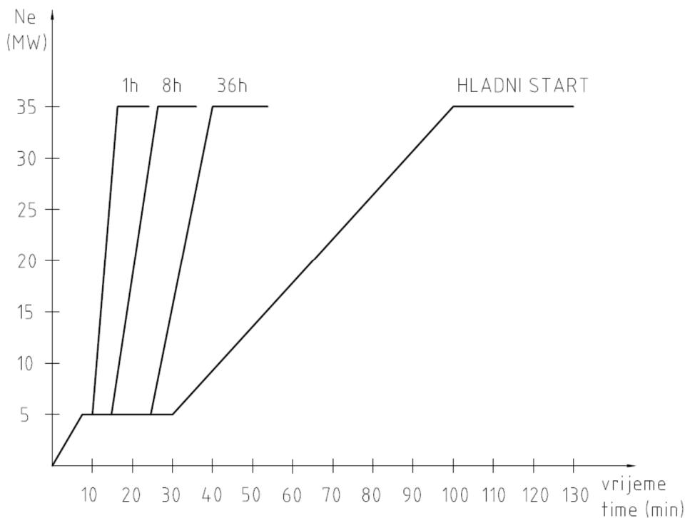
Slika 2. Dijagram opterećenja turbine u ovisnosti o vremenu zastojia, [6]
