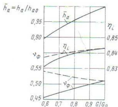
**Slika 15. Promjena entalpijskog pada, karakteristike  $V_{srR0} = u / c_{F0}$  i unutarnje iskoristivosti međustupnja na promjenjivim režimima kod regulacije grupama sapnica**
