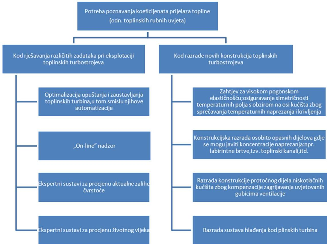
**Slika 23. Najčešći zadaci za čije je rješenje potrebno određivanje toplinskog i napregnuto-deformabilnog stanja sklopova i elemenata turbine (tj. temperturnih polja i s njima povezanih c) što iziskuje poznavanje toplinskih rubnih uvjeta (tj. koeficijenata prijelaza topline)**
