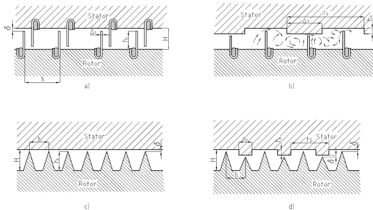
Slika 27. Osnovni tipovi labirintnih brtvi koji se susreću kod parnih i plinskih turbina
