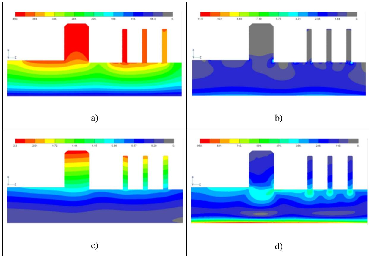
Slika 42. Detalj rotora; a)Temperaturno polje ( $^{\circ}\text{C}$ ), b)Ukupni temperaturni gradijent, c)Radijalna deformacija (mm) usljeđ temperaturenog polja i vrtnje, d)HMH naprezanja ( $\text{N/mm}^2$ ) usljeđ temperaturenog polja i vrtnje
