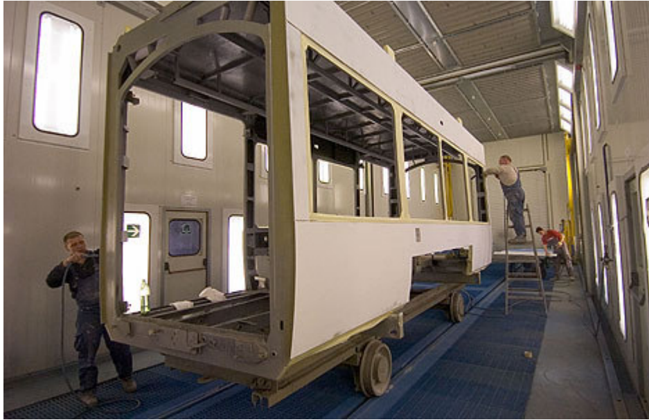
Slika 21: Zaštita i lakiranje tramvaja [20]
