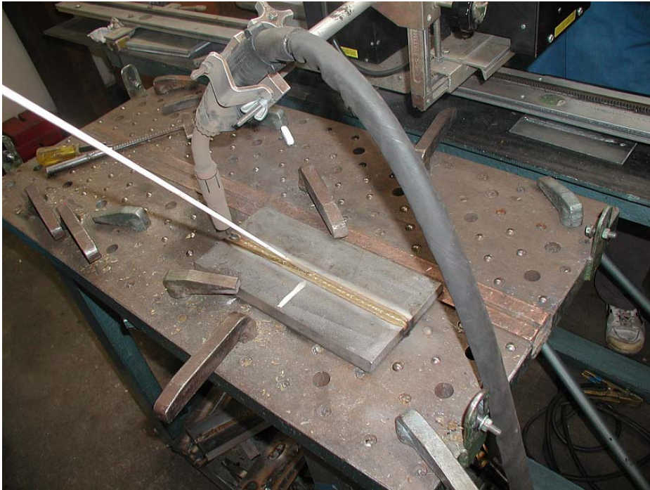
Slika 7.50 Način uranjanja termo-para Ni-CrNi u talinu
