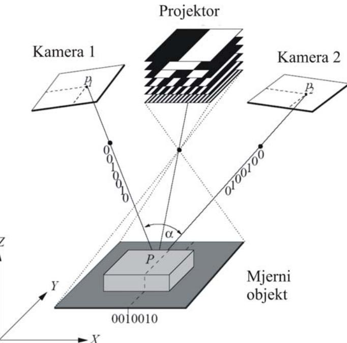
Slika 20. Princip projekcijskog senzora "Atos", Izvor <http://www.gom.com>
