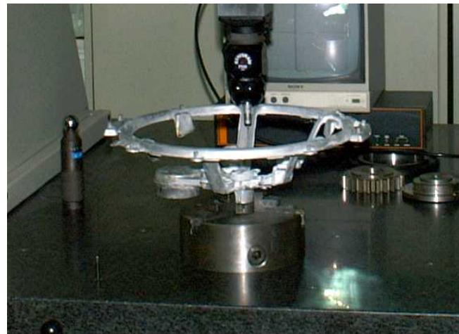
Slika 58. Prihvatanje mjernog objekta
