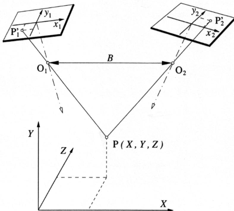
Slika 23. Triangulacija položaja točke  $P$  primjenom dvije kamere
