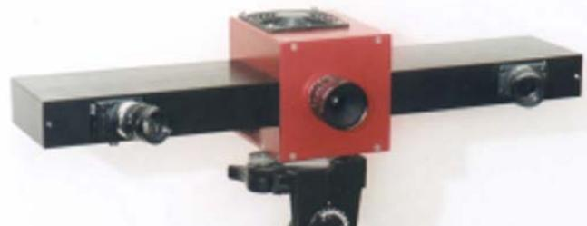
Slika 19. Projekcijski mjerni senzor "Atos"
