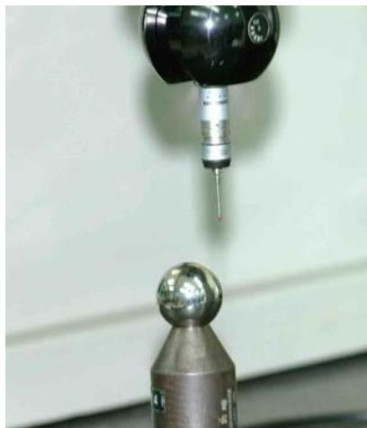
Slika 57. Kalibracija ticala kuglastim kalibrom
