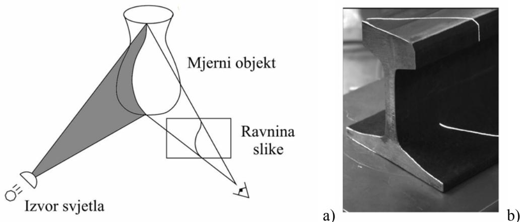
Slika 12. a) shematsizirana postava laserskog linijskog projekcijskog sustava ; b) sa fotografijom projicirane linije
