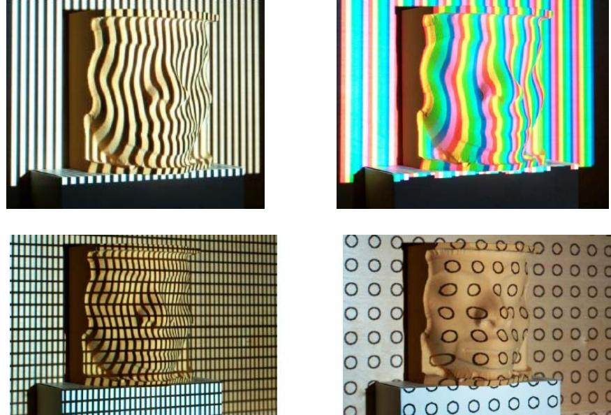
Slika 16. Neke od varijanti projiciranih strukturiranih svjetlosnih uzoraka
