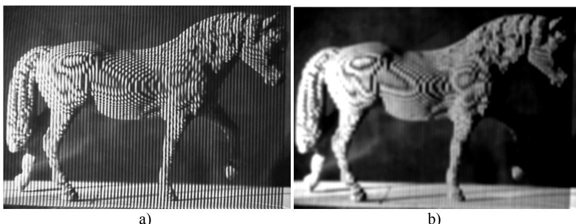
Slika 18. Primjer interferometrijskog mjerjenja oblika Moire efektom
