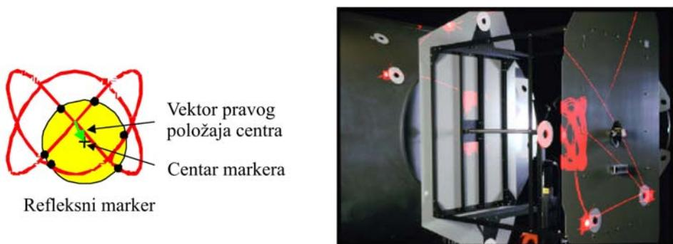
Slika 13. Putanja laserske zrake po zatvorenoj Lissajousovoj krivulji
