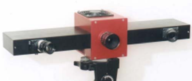
Slika 19. Projekcijski mjerni senzor "Atos"
