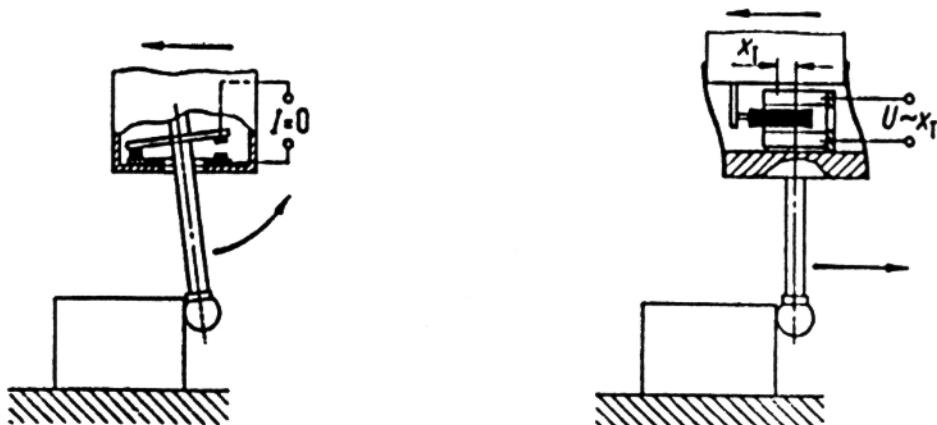
Slika 35. Princip djelovanja "trigger" i analogue mjerne glave
