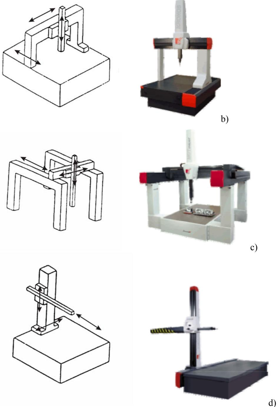
Slika 9. Shematizirani prikaz i realne izvedbe nekih osnovnih tipova TMU,
