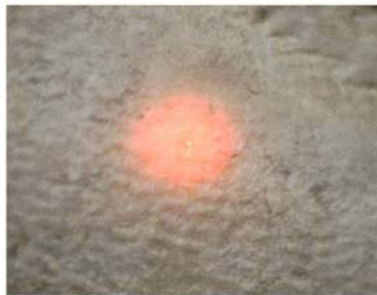
Slika 42. Gubitak definicije točke zbog prodiranja projicirane zrake u osnovni materijal
