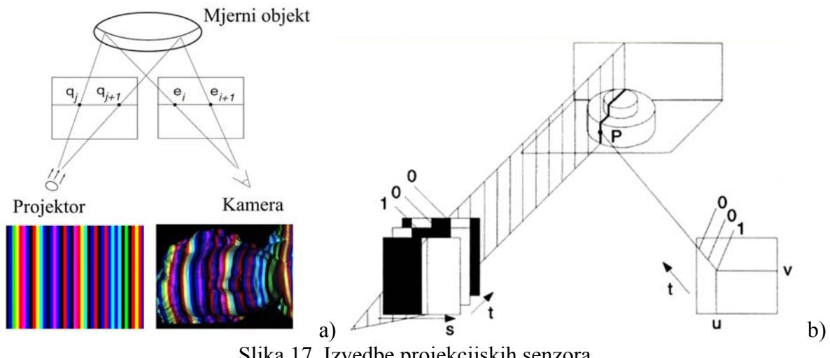
Slika 17. Izvedbe projekcijskih senzora
