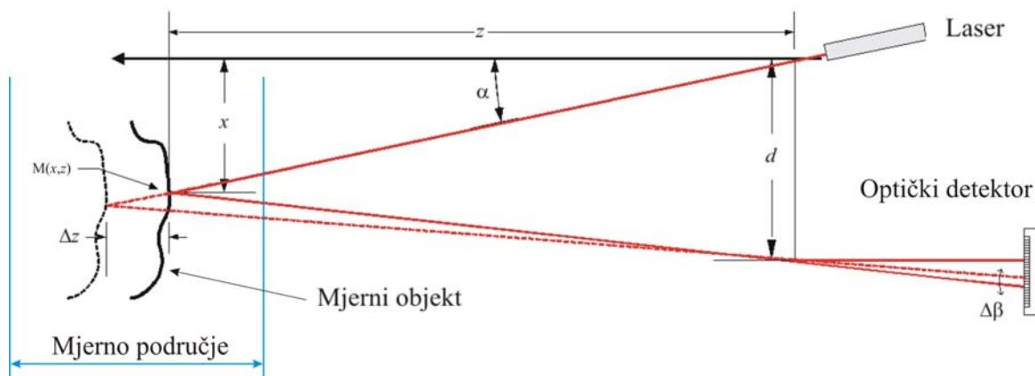
Slika 28. Princip triangulacije
