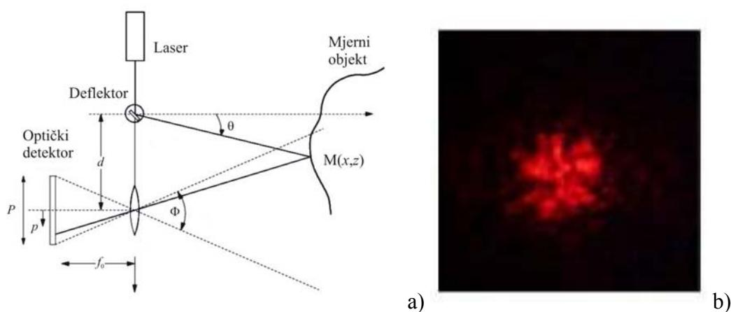
Slika 11. Shematski prikaz postave *single point* senzora a) sa fotografijom projicirane točke b)
