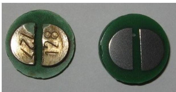
Slika 3.13. Uzorci nodularnog lijeva pripremljeni za metalografsku analizu
