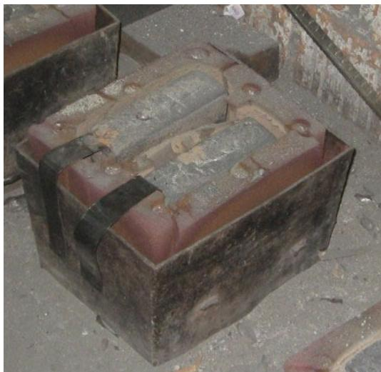
Slika 3.6. Hlađenje dviju odljevenih Y – proba u kalupu
