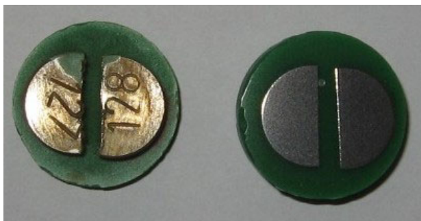
Slika 3.13. Uzorci nodularnog lijeva pripremljeni za metalografsku analizu
