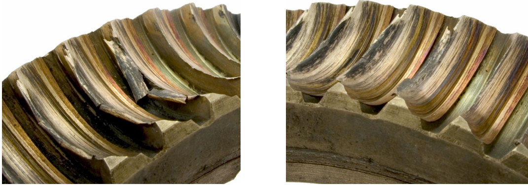
Slika 5.4 Istrošenost zubi pužnog kola
