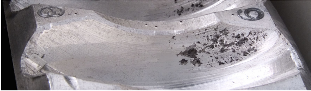
Slika 10.1 Zub br. 6 pužnog kola AlSn6 nakon 5,02 \cdot 10^6 izmjena
