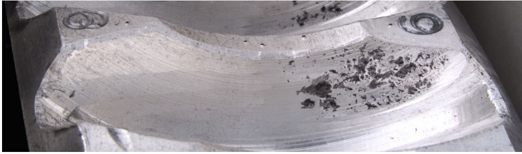
Slika 10.1 Zub br. 6 pužnog kola AlSn6 nakon 5,02 \cdot 10^6 izmjena
