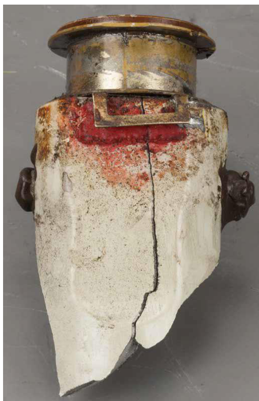
Slika 20: Prikaz pukotine i korozije na osovini glavnog podvozja zrakoplova BA Jetstream 31 [34] Cilindar podvozja izrađen je od aluminijske legure 5094 čiji je glavni legirni element magnezij. Zbog svoje visoke čvrstoće i otpornosti prema utjecaju morskog okoliša, navedena legura bila je logičan izbor. Unutar cilindra nalazi se klizna cijev na koju je montiran sklop kotača i kočnica. Navedena
