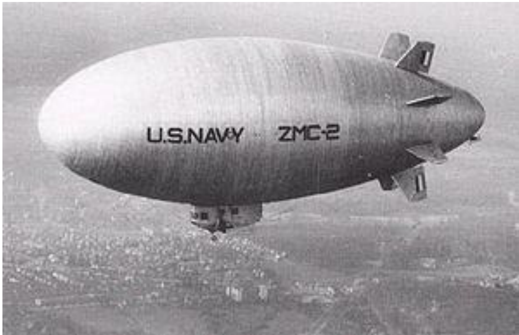
Slika 9: Zračni brod ZMC-2 – prvi zrakoplov na kojemu je korišten Alclad [21]
