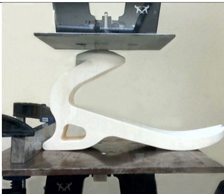
Slika 15. Modificirana verzija proteze Niagara Foot [29]
