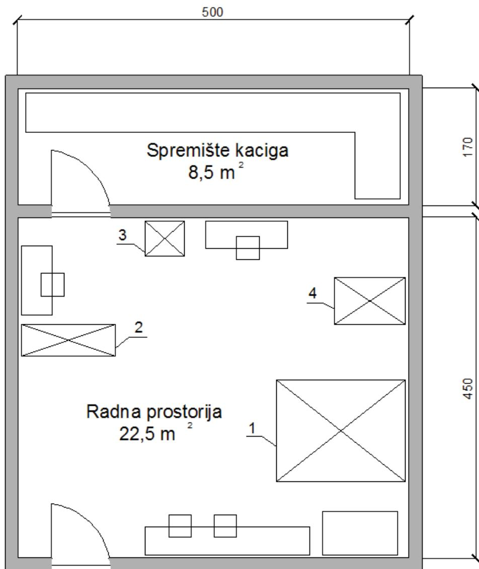
**Slika 9.1.** Tlocrt laboratorija i minimalan potreban prostor za smještaj minimalnog seta uredaja za ispitivanje kaciga, prema ECE-R22.05 pravilniku.
