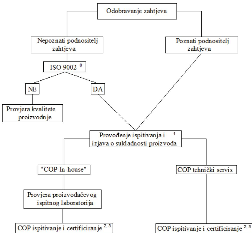
**Slika 7.1.** Dijagram toka postupka provjeravanja sukladnosti proizvodnje. Napomene: <sup>0</sup> ili bilo kakav drugi oblik ispitivanje kvalitete; <sup>1</sup> Provodi tehnički servis proizvođača ili nezavisni akreditirani ispitni laboratorij; <sup>2,3</sup> Ukoliko proizvođač zadovoljava ISO 9002 ispitivanje provoditi jednom godišnje, ako ne zadovoljava ispitivanje provoditi tri puta godišnje.
