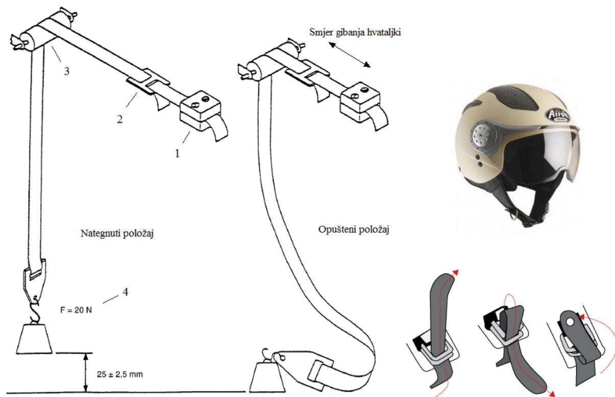
**Slika 5.13.** Lijevo: Shematski prikaz uređaja za ispitivanje proklizavanja sustava za vezivanje kacige (1-pomična kliješta, 2-sustav za pritezanje, 3-rotirajući valjak, 4-uteg). Desno: princip spajanja vezice na kacigu.
