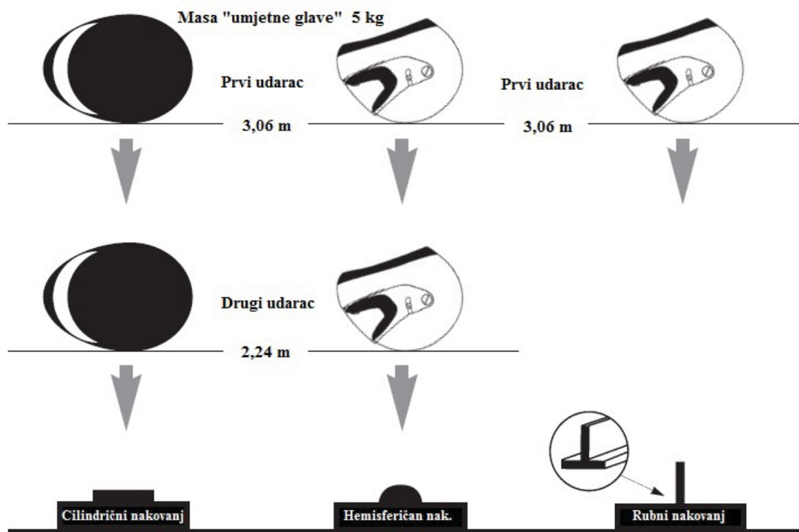
Slika 8.1. Ispitivanje apsorpcije energije sudara prema Snell-u.
