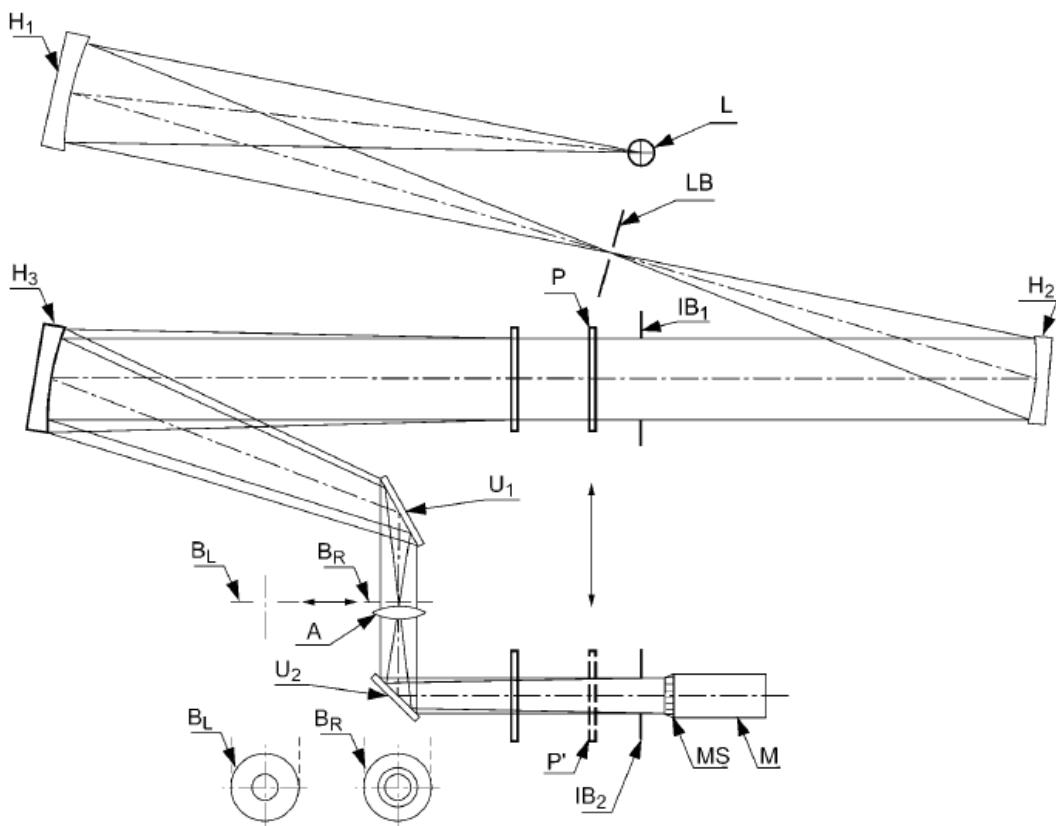
**Slika 5.20.** Shematski prikaz aparata za mjerjenje difuzije svjetla.
