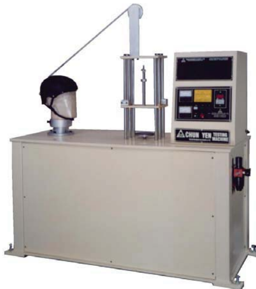
Slika 9.4. Uređaj za ispitivanje odvajanja kacige ( Chun Yen ).
