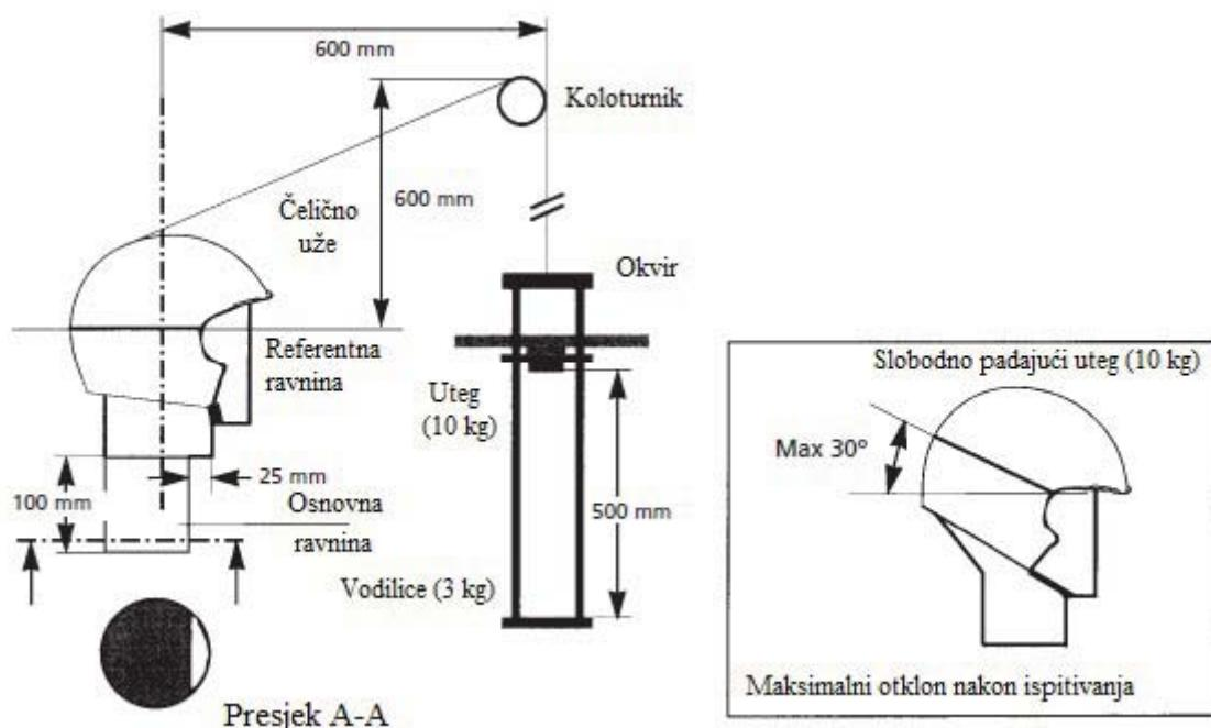
**Slika 5.12.** Shematski prikaz uređaja za ispitivanje odvajanja kacige.
