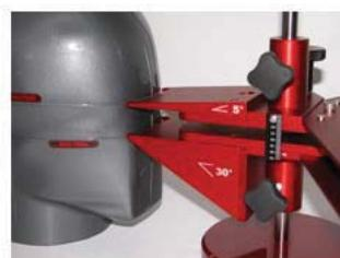
Mjerenje vertikalnog vidnog polja
