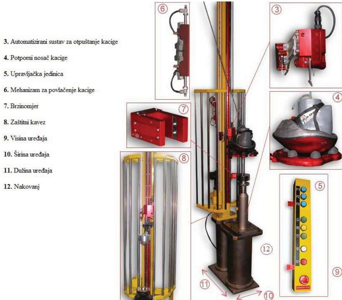
**Slika 9.6.** Uređaj za ispitivanje apsorpcije energije sudara - donji dio (*Cadex*).
