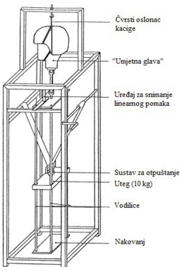
**Slika 5.11.** Shematski prikaz uređaja za ispitivanje dinamičke izdržljivosti sustava vezanja kacige.
