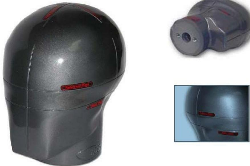
Donji dio "umjetne glave" s pripremljenim provrtom gdje se smješta akcelerometar
