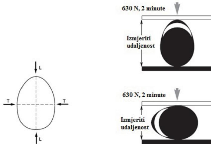
**Slika 5.9.** Shematski prikaz ispitivanja krutosti kacige (opterećenja) transverzalno (T-T) i longitudinalno (L-L).
