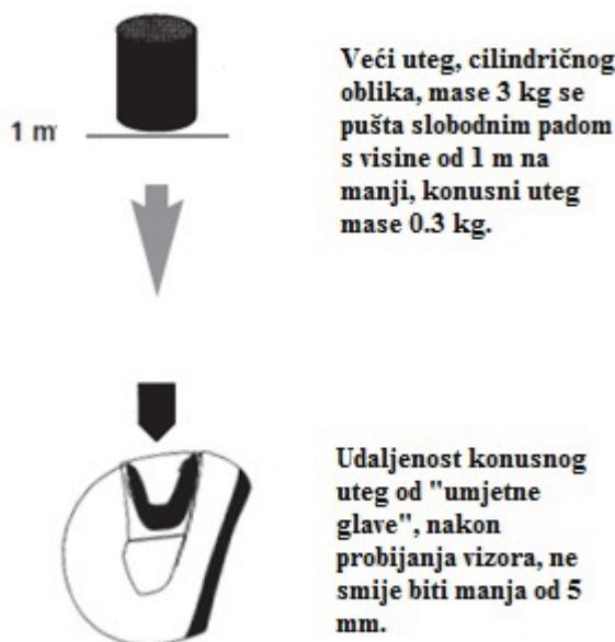
**Slika 5.22.** Ispitivanje mehaničkih svojstava vizora (penetrirajući test).
