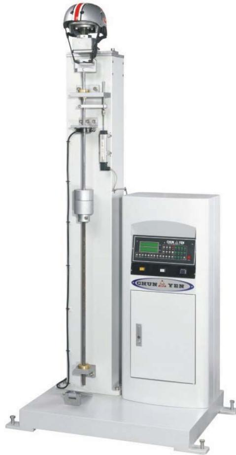
**Slika 9.3.** Uredaj za ispitivanje dinamičke izdržljivosti sustava vezanja kacige (*Chun Yen*).
