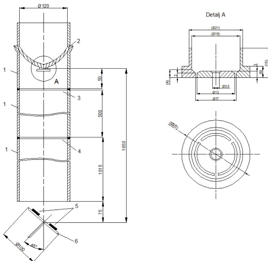
**Slika 5.23.** Uređaj za ispitivanje vizora na abraziju. Dijelovi: 1. PVC cijev 2. Spremnik s pjeskom 3. Gornje sito 4. Donje sito 5. Testni uzorak 6. Rotirajuća platforma.
