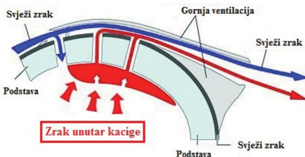
**Slika 2.5.** Sustav ventiliranja zraka unutar kacige.
