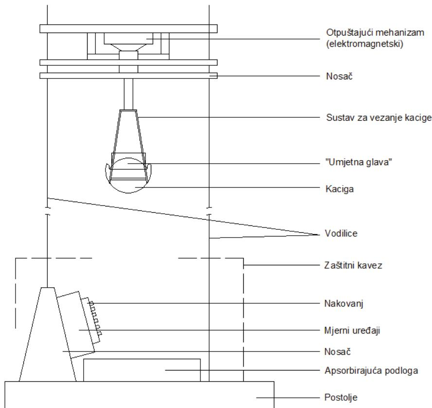
**Slika 5.8.** Shematski prikaz uređaja za ispitivanje abrazije kacige.
