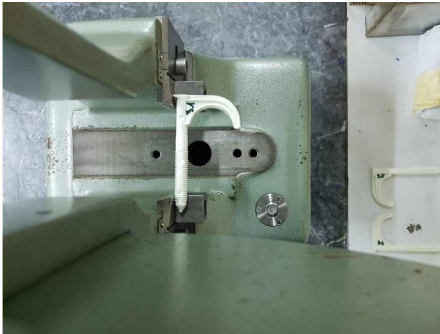
Slika 5.7. Tvorevina pozicionirana na Charpyevom batu
