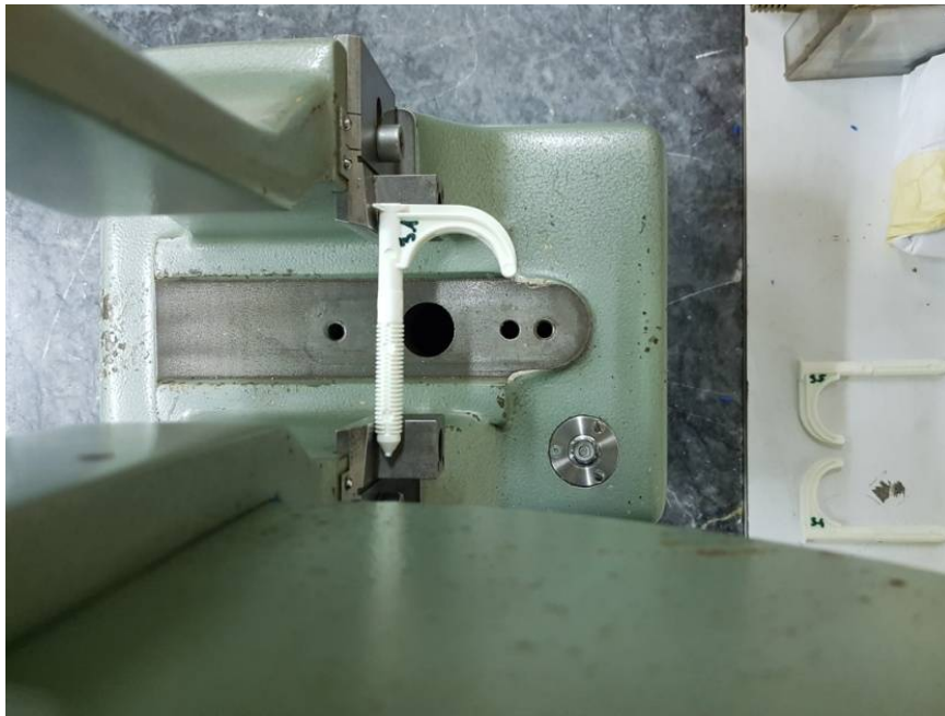
Slika 5.7. Tvorevina pozicionirana na Charpyevom batu
