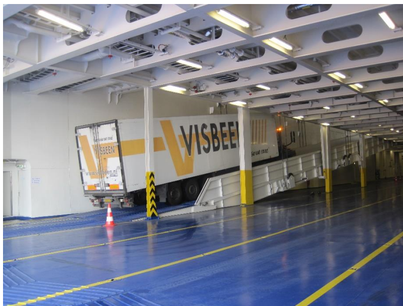
Slika 2. Unutrašnja rampa Ro-Ro broda
