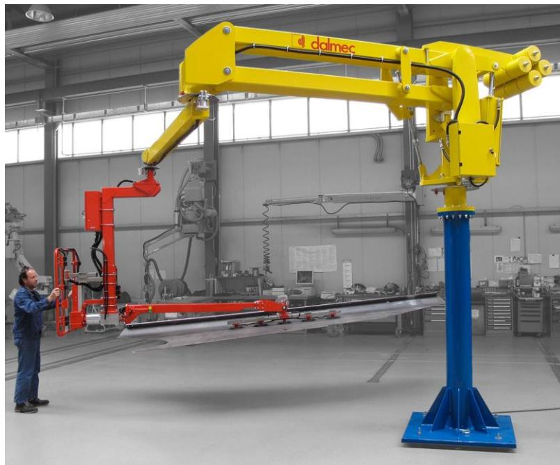
Slika 3. Primjer pneumatskog pogona manipulatora
