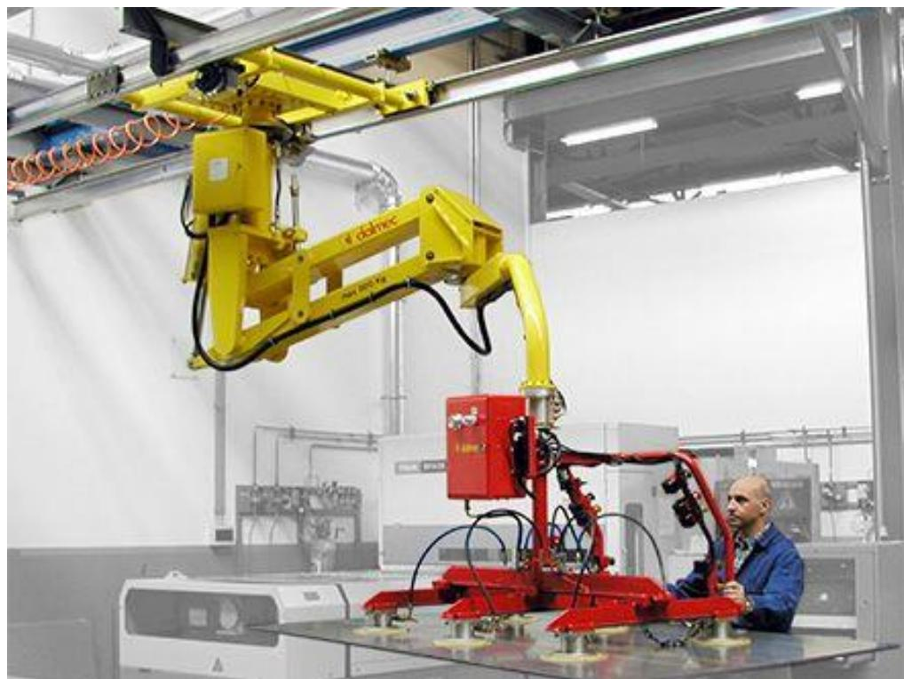
**Slika 7. Mobilni stropni manipulator**
