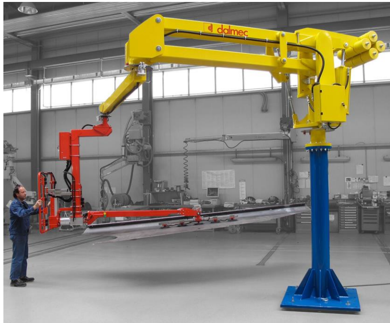
Slika 3. Primjer pneumatskog pogona manipulatora
