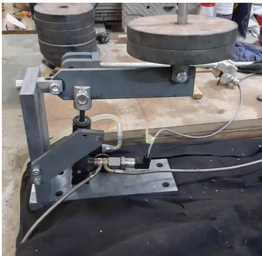
Slika 24. Pomoćna naprava opterećena s 2 utega
