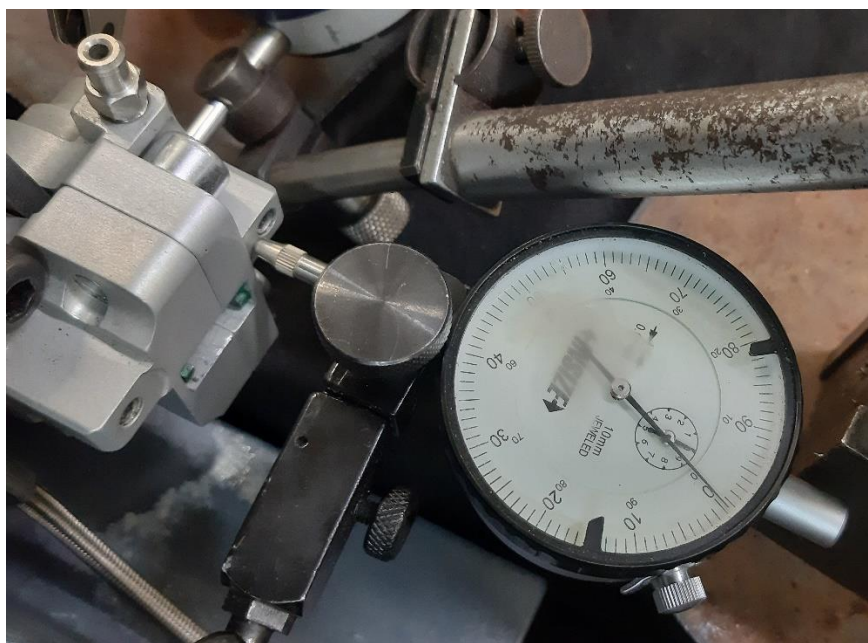
Slika 37. Mjerenje točke T5 na čeljusti stražnjih kočnica
