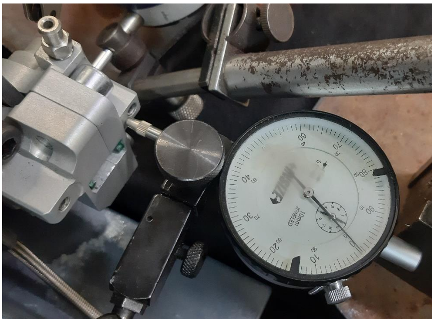
Slika 37. Mjerenje točke T5 na čeljusti stražnjih kočnica
