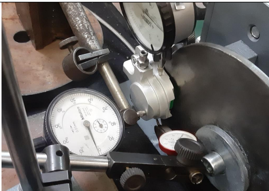
Slika 36. Mjerenje točke T2 na čeljusti stražnjih kočnica
