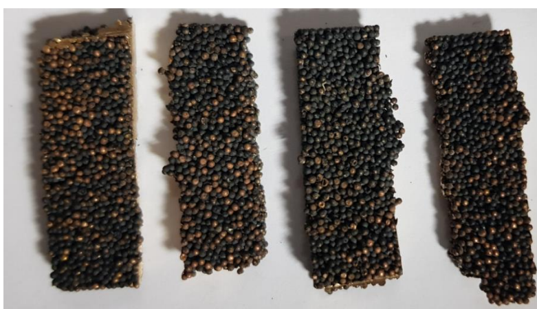
Slika 31. Izrezani uzorci iz zaštitne atmosfere argona
