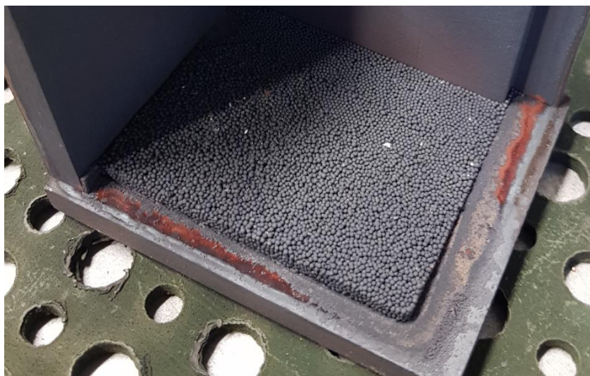
Slika 28. Prah 600/1000 nakon sinteriranja u zaštiti argona
