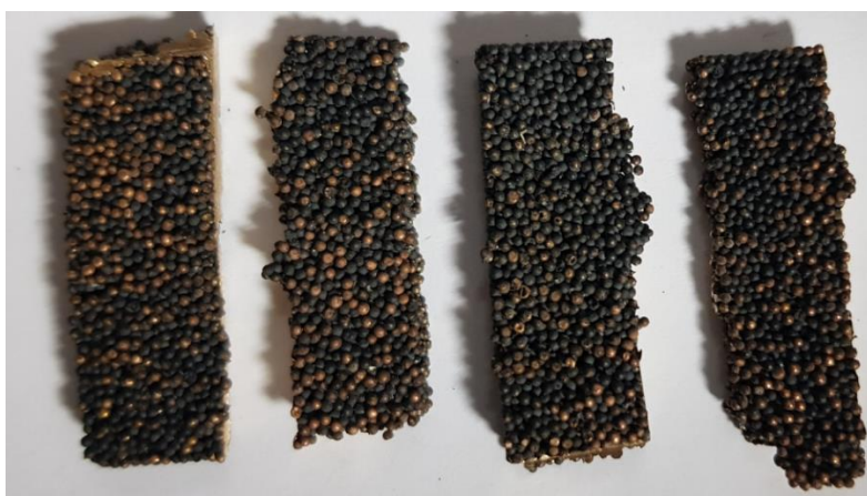
Slika 31. Izrezani uzorci iz zaštitne atmosfere argona
