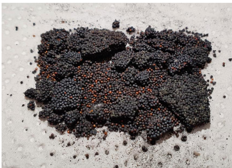
Slika 18. Rezultat sinteriranja bez zaštitne atmosfere
