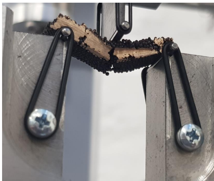
Slika 36. Lom ispitnog uzorka
