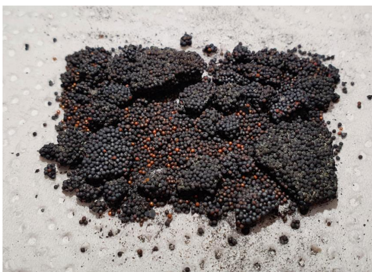
Slika 18. Rezultat sinteriranja bez zaštitne atmosfere
