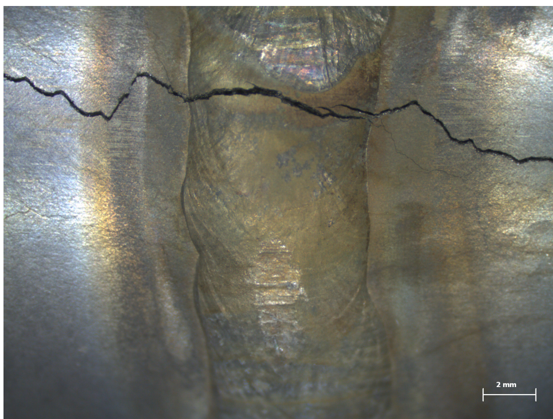
Slika 118: Stereomikroskopski snimci razgranatosti pukotina u osnovnom materijalu, ZUT-u i u materijalu navara – Uzorak 20; AISI 304
