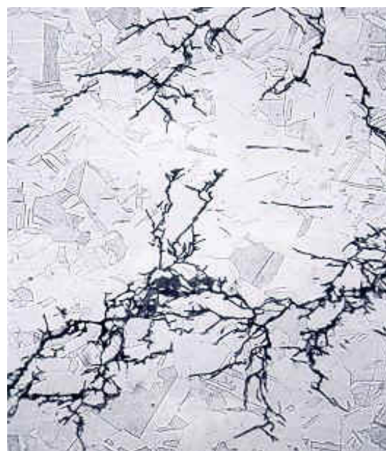
Slika 39: Napetosna korozija AISI 316 čelika – transkristalan lom [18]
