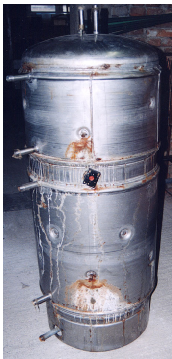
Slika 76: Kotao za dogrijavanje vode u sustavu solarnog grijanja (materijal izrade - AISI 304)
