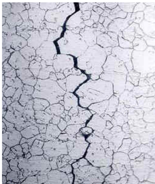
Slika 38: Napetosna korozija AISI 304 čelika – interkristalan lom [18]
