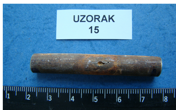
Slika 96: Odabrani uzorci za daljnju analizu korozivski procesa zaštitnih cijevi grijača (Serije II) materijal AISI 304
