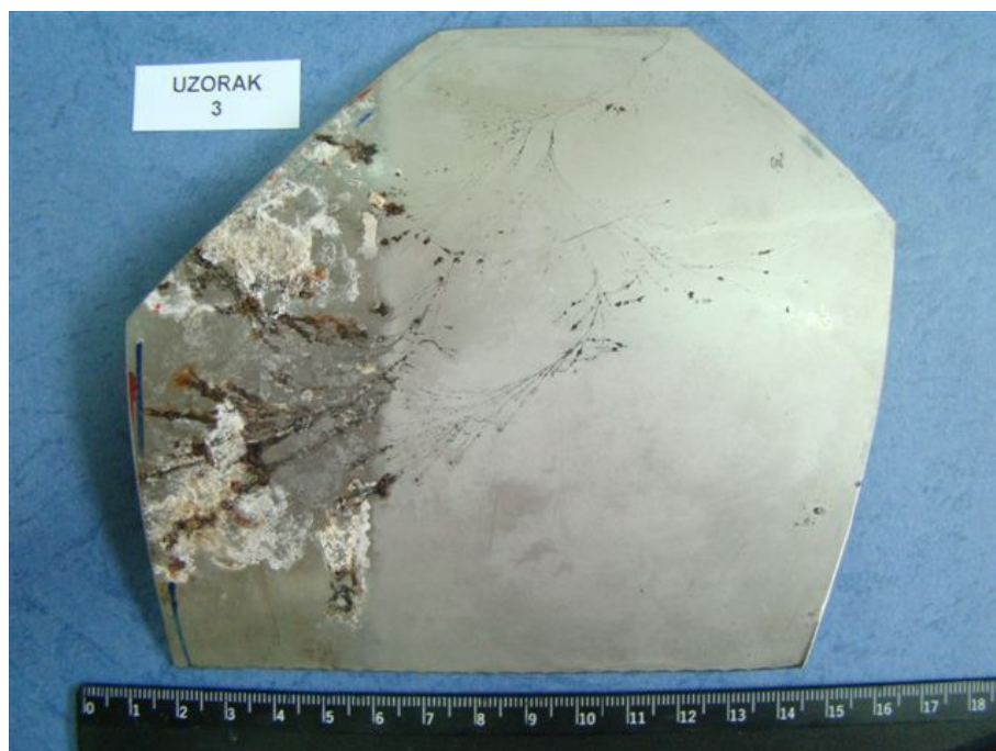
Slika 64: Izgled površine uzorka poslije čišćenja (uklanjanja produkata korozije) – Uzorak 3
