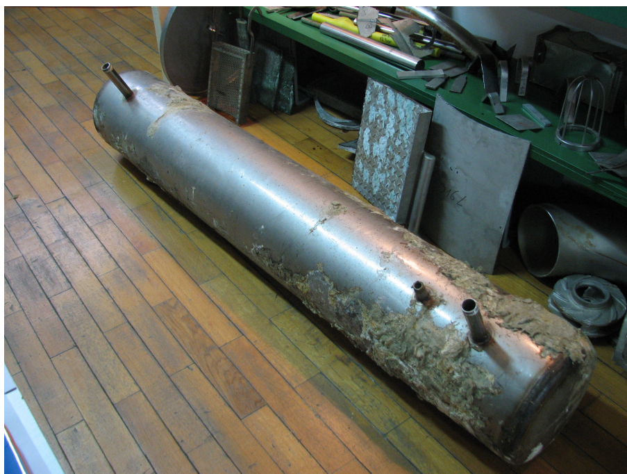
Slika 57: Kotao za dogrijavanje vode u pogonu pekare (snimljeno u Laboratoriju za zaštitu materijala)
