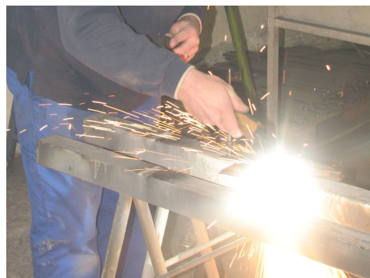
Slika 59: Postupak rezanja uzoraka
