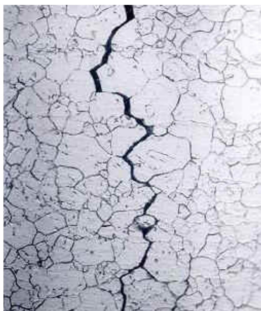
Slika 38: Napetosna korozija AISI 304 čelika – interkristalan lom [18]
