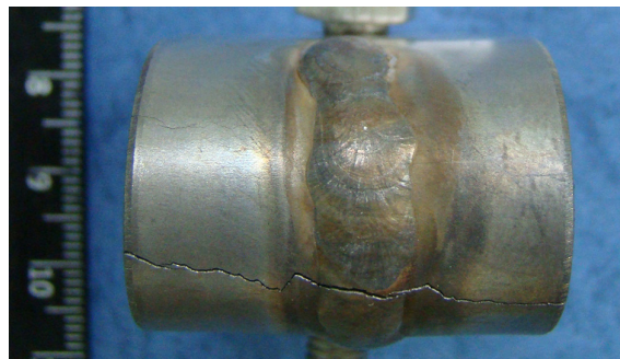
Slika 111: Uzorci 20 – austenitni Cr-Ni čelik kvalitete AISI 304 – osnovni materijal (lijevo) i navar (desno)
