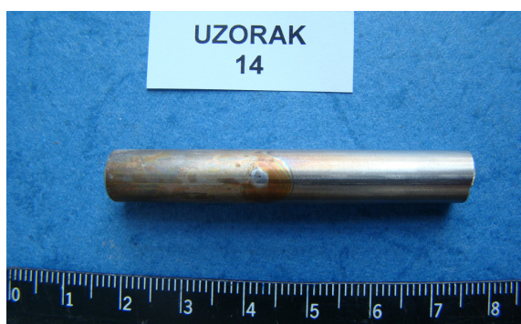
Slika 96: Odabrani uzorci za daljnju analizu korozivski procesa zaštitnih cijevi grijača (Serije II) materijal AISI 304
