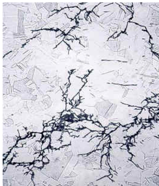
Slika 39: Napetosna korozija AISI 316 čelika – transkristalan lom [18]
