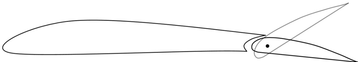
**Slika 4      Shematski prikaz profila s krilcem „Frise aileron“**
