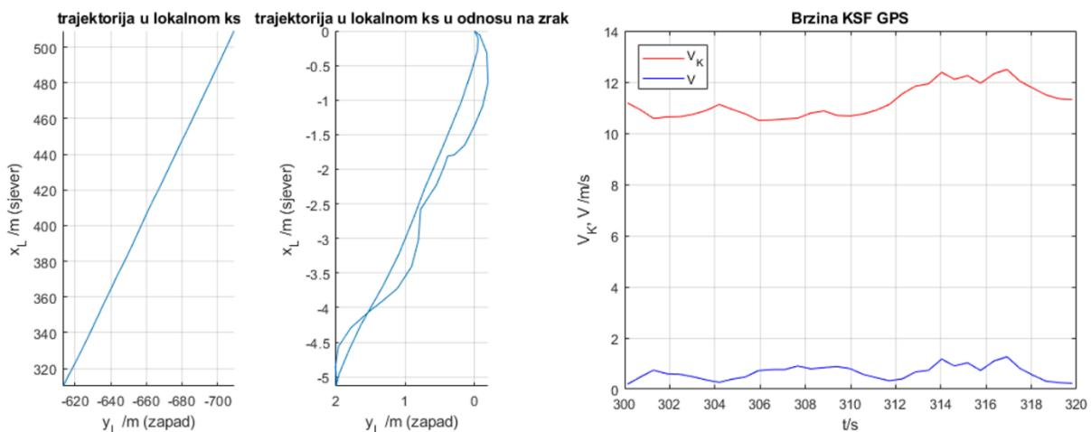
**Slika 31** Prikaz trajektorije u odnosu na zemlju (lijevo) i u odnosu na zrak (sredina) te brzine i aerodinamičke brzine u vremenu (desno)
