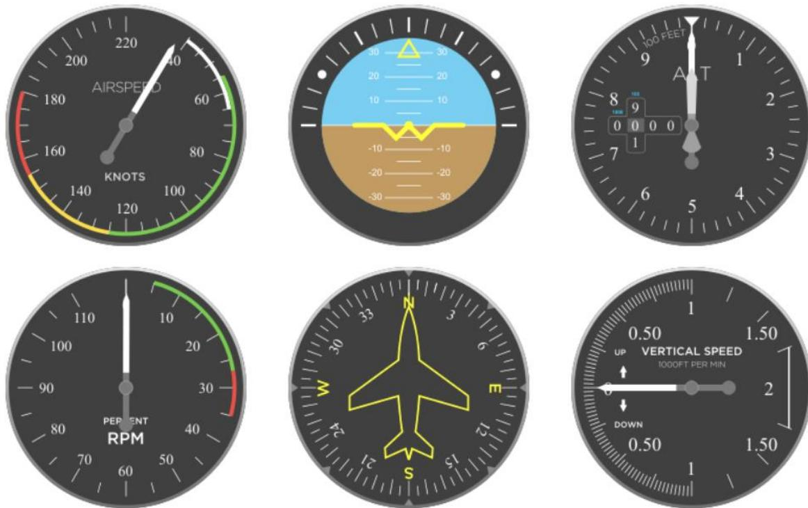
**Slika 22 Prikaz instrumenata na zaslonu ispred pilota**
