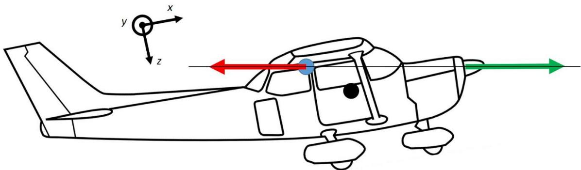
**Slika 7 Shematski prikaz vektorâ sile otpora i pogonske sile za motor s postavnim kutom prema dolje**
