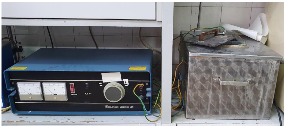
Slika 32. Uređaj za elektrokemijsko nagrizanje „DELAVNIŠKI USMERNIK UZR“, Laboratorij za zaštitu materijala, FSB Zagreb
