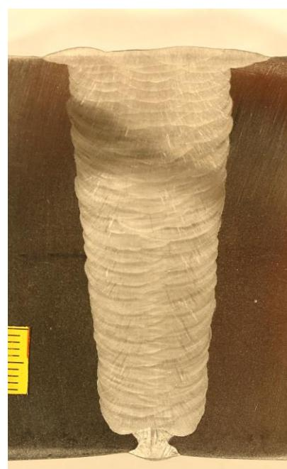
**Slika 33.** Izgled pripremljenog makroizbruska za mjerjenje udjela ferita i ispitivanje mikrostrukture
