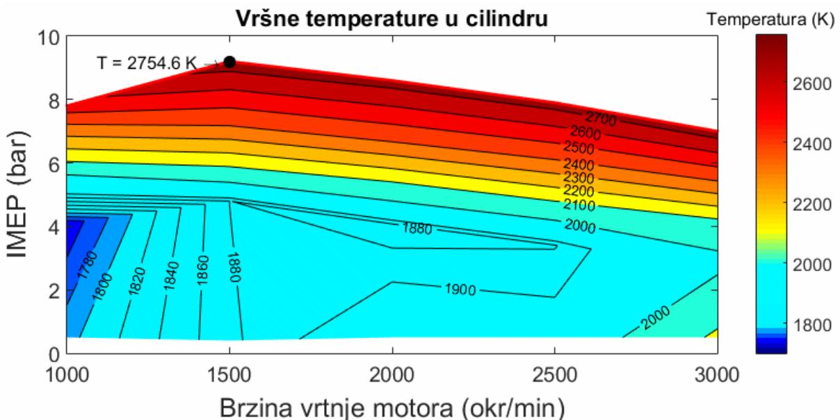
Slika 35. Topografski dijagram vršnih temperatura u cilindru
