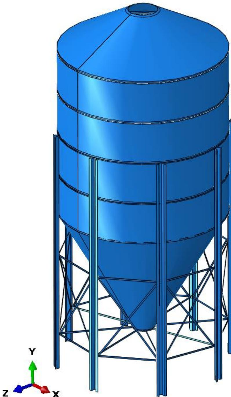
**Slika 6.3. Sklop silosa u *Abaqusu***
