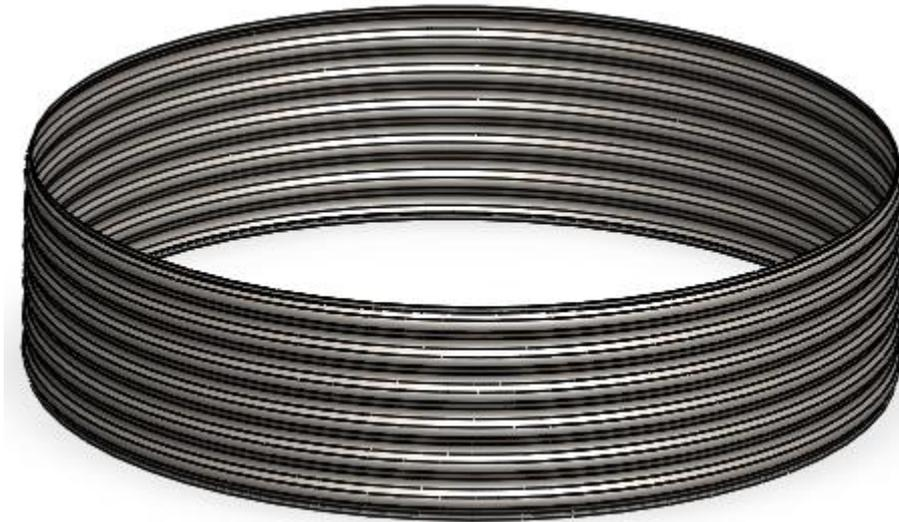
**Slika 2.5. Cilindrični odjeljak od valovitog lima**
