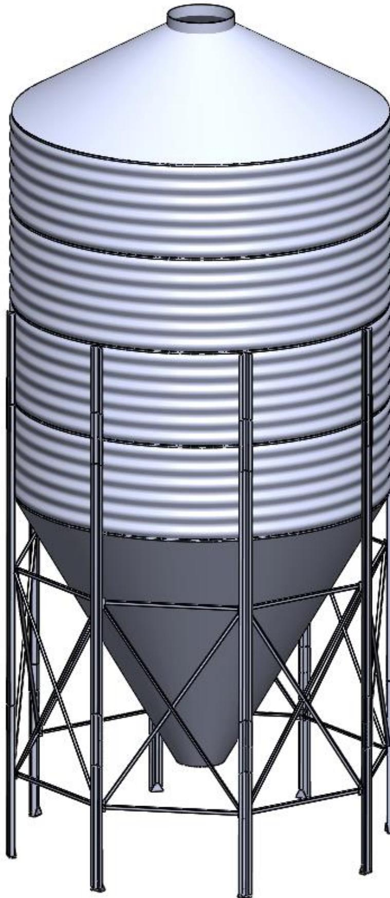
Slika 2.8. Nosiva konstrukcija silosa
