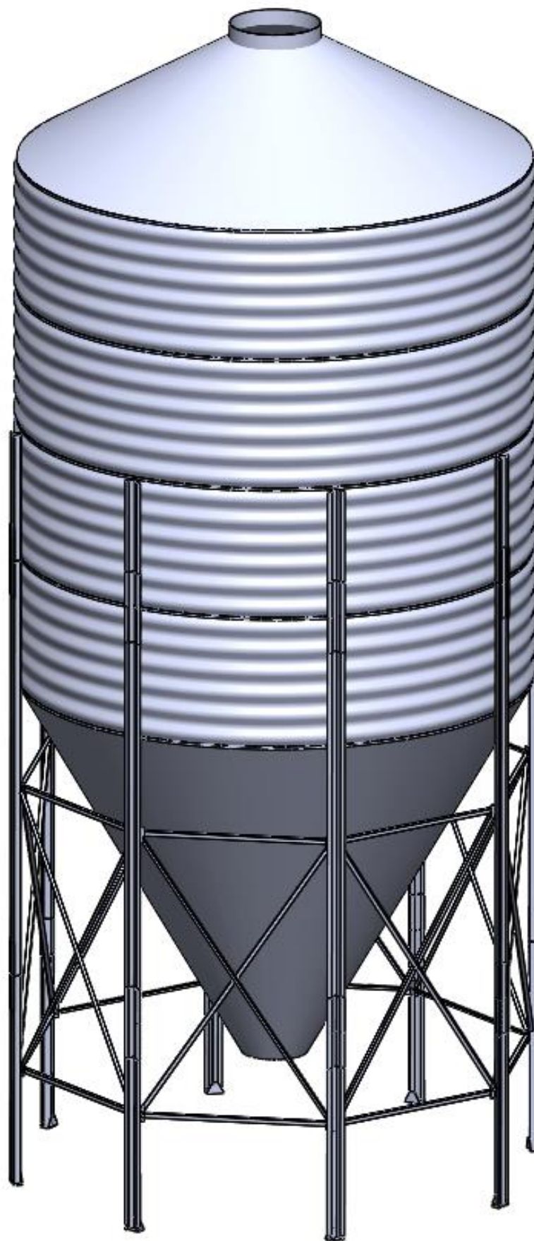
Slika 2.8. Nosiva konstrukcija silosa
