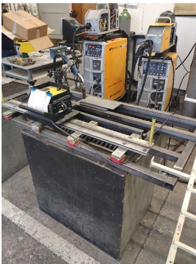
Slika 28. Uređaj za automatsko upravljanje Bugo System
