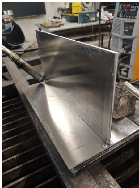
Slika 42. Prikaz položaja ploča i pištolja prije MIG zavarivanja
