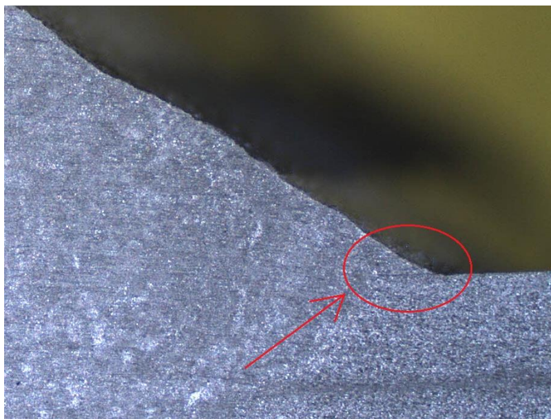
Slika 64. Pogreške u zavaru, P-GMAW
