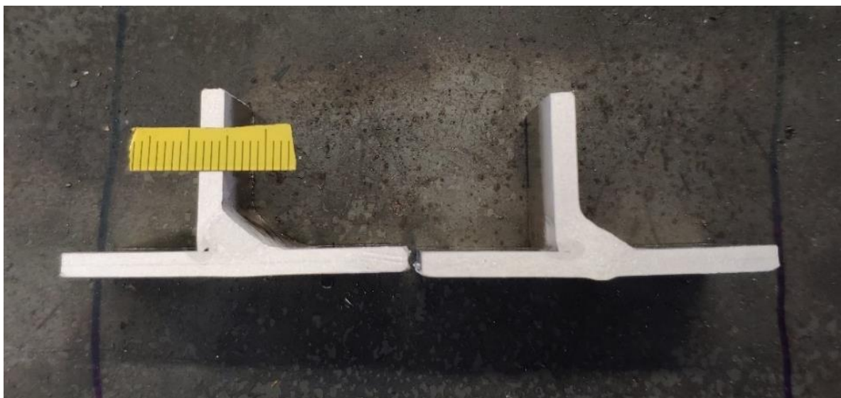
Slika 54. Makroizbrusci nakon postupka nagrivanja
