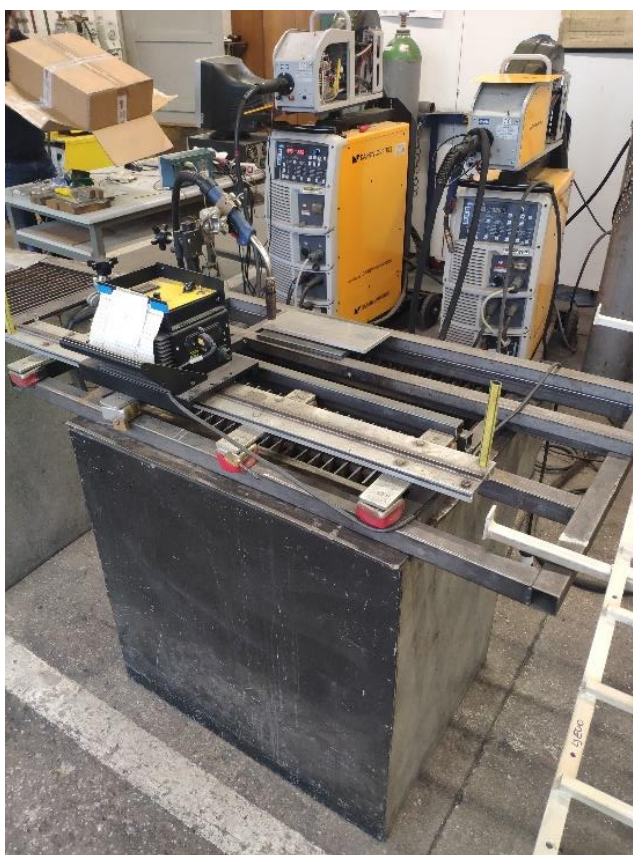
Slika 28. Uređaj za automatsko upravljanje Bugo System
