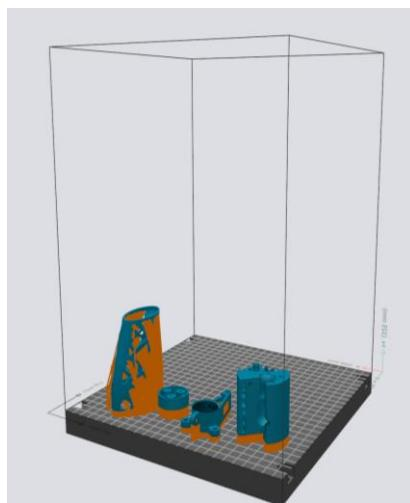
**Slika 20. Modeli s potpornim strukturama u softveru *EOSPRINT 2.8***
