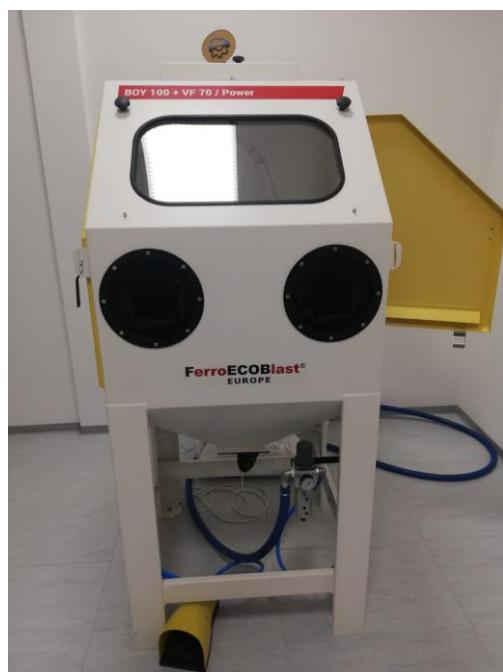
**Slika 26. Uredaj za pjeskarenje FerroECOBlast**
