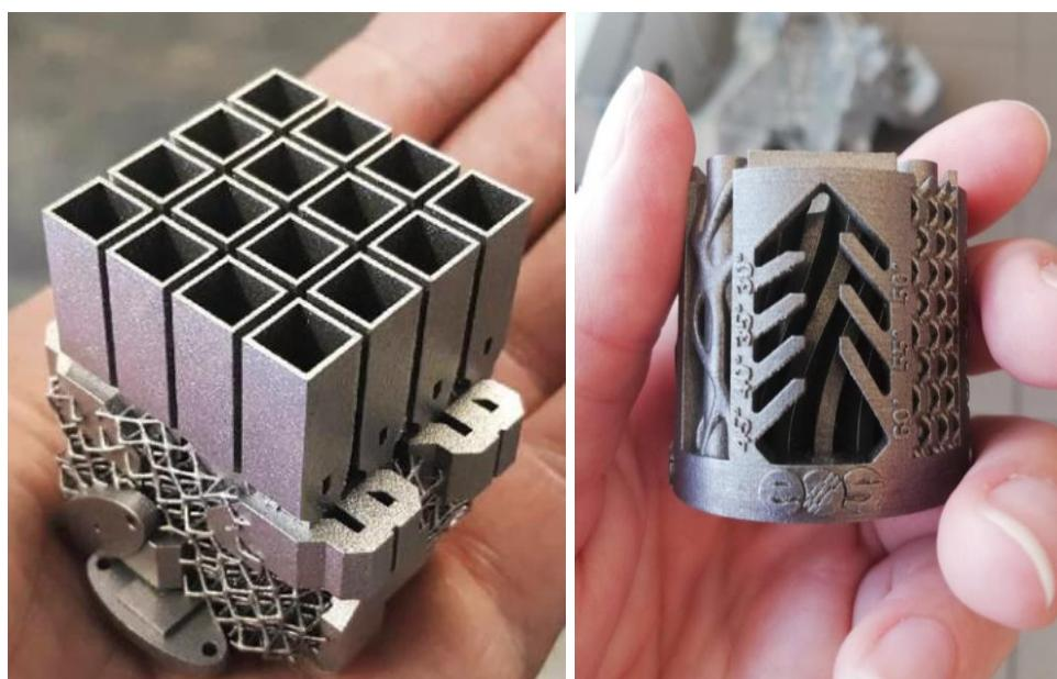
Slika 3. Prikaz modela izrađenih DMLS proizvodnim postupkom [4], [5]
