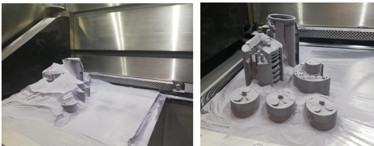
Slika 24. Postupak uklanjanja viška praha s radne plohe
