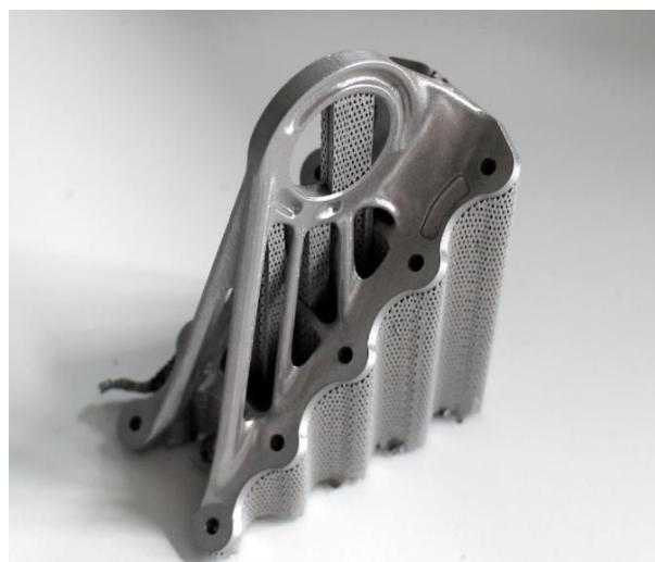
Slika 14. Metalni nosač pod orijentacijom od  $45^\circ$  prije uklanjanja potpornih struktura [20]
