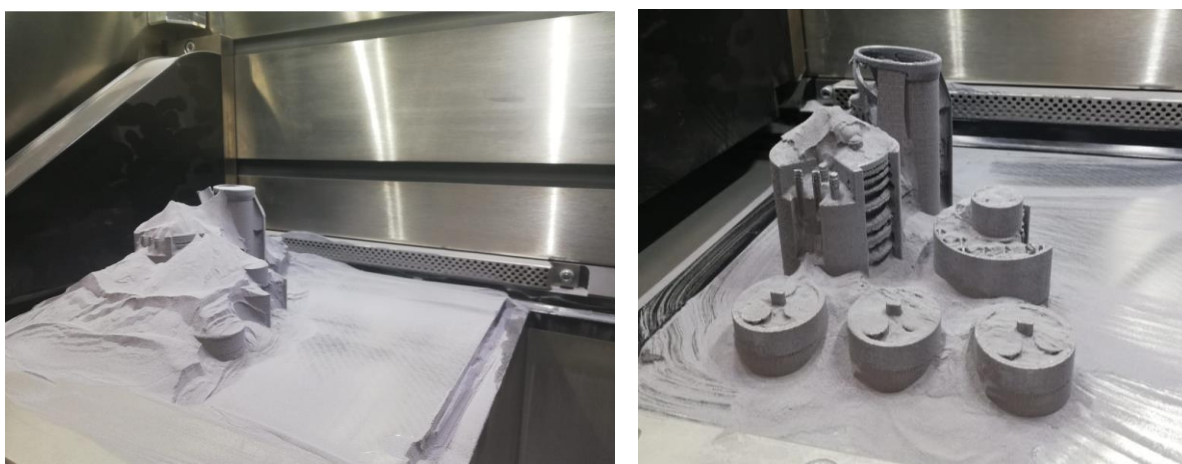
Slika 24. Postupak uklanjanja viška praha s radne plohe
