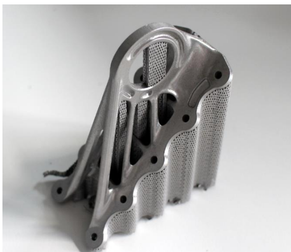
Slika 14. Metalni nosač pod orijentacijom od 45° prije uklanjanja potpornih struktura [20]
