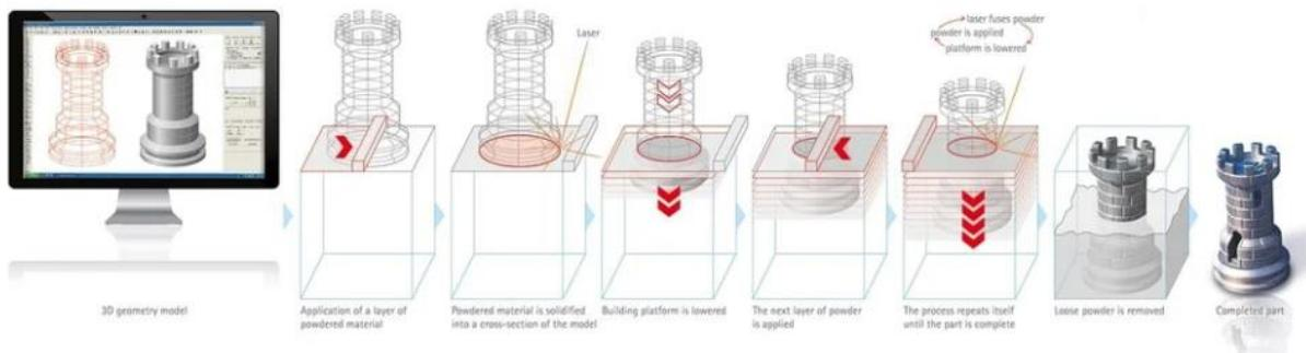
Slika 5. Postupak izrade modela DMLS proizvodnjim postupkom [5]
