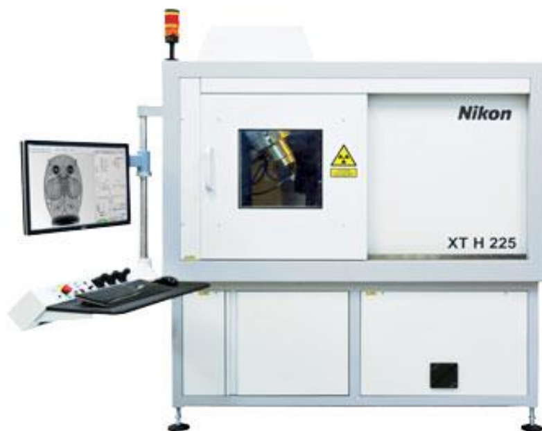
Slika 8.6 CT uređaj Nikon XT H 225 [36]
