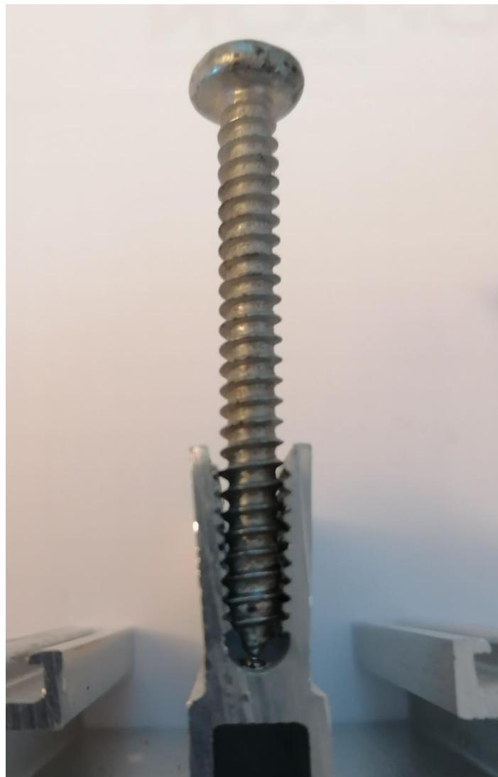
Slika 53. Deformacija stijenke profila izazvana pritezanjem vijka
