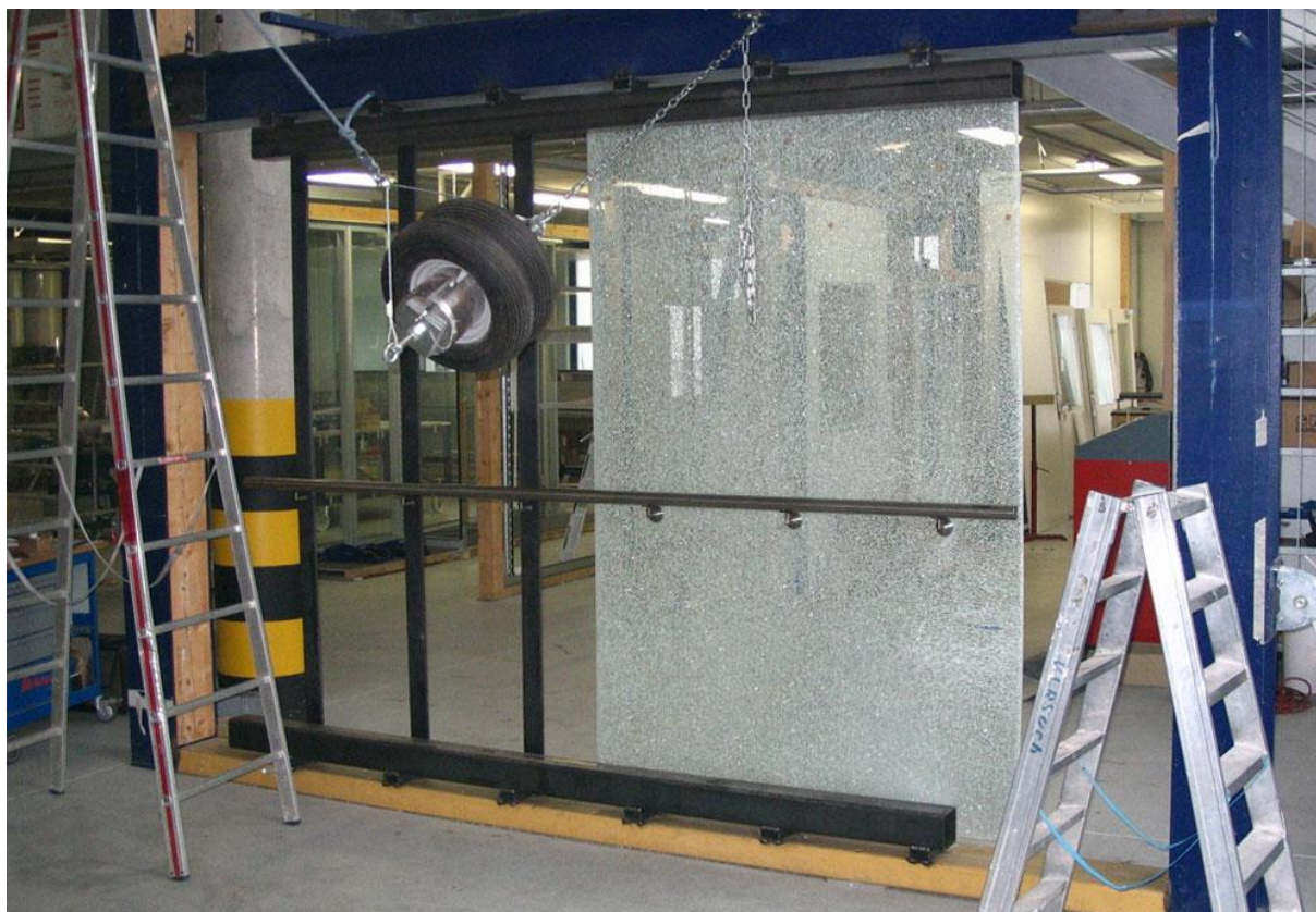
Slika 26. Ispitivanje na udarni lom stakla
