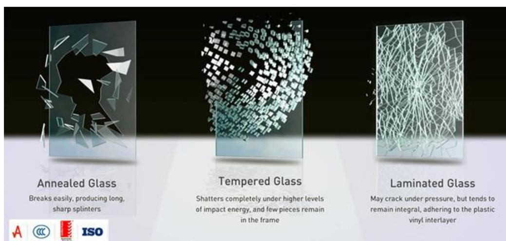
Slika 18. Usporedba različitih tipova stakla uslijed pucanja
