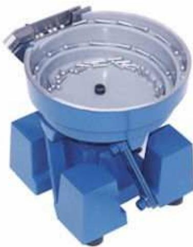
Slika 24. Vibracijski dodavač sa zdjelom [18]
