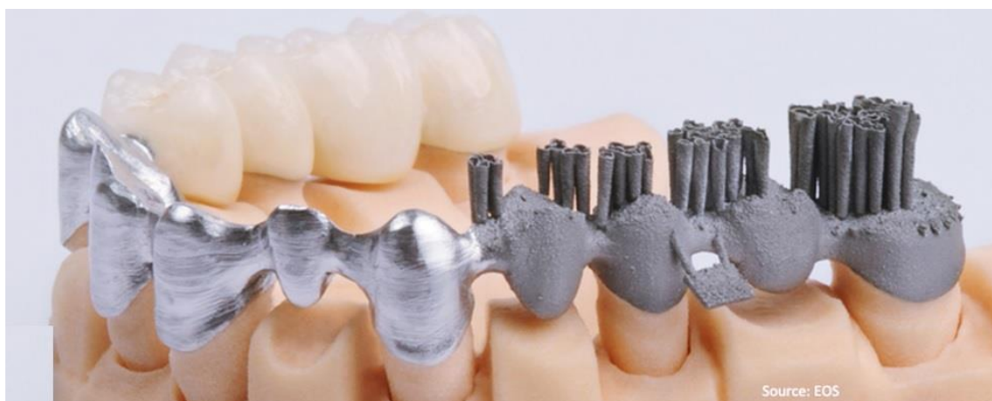
Slika 7. Zubni most proizveden 3D printanjem [11]
