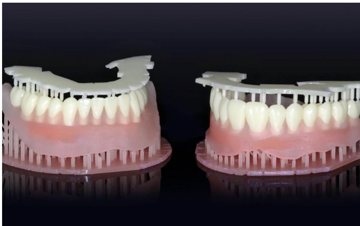
Slika 4. Dentalni implantat proizveden 3D printanjem [7]
