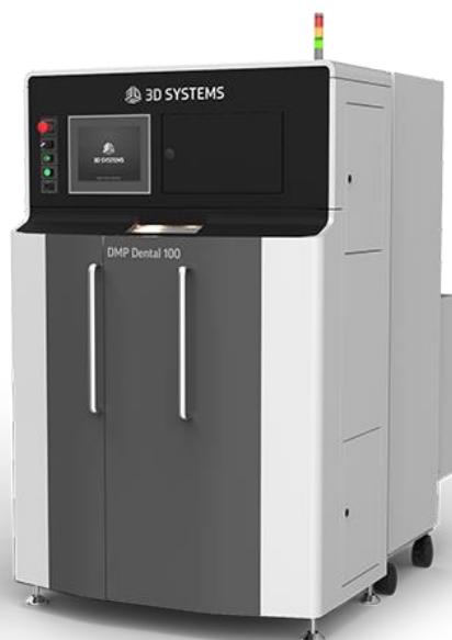
Slika 10. 3D printer DMP Dental 100 [26]
