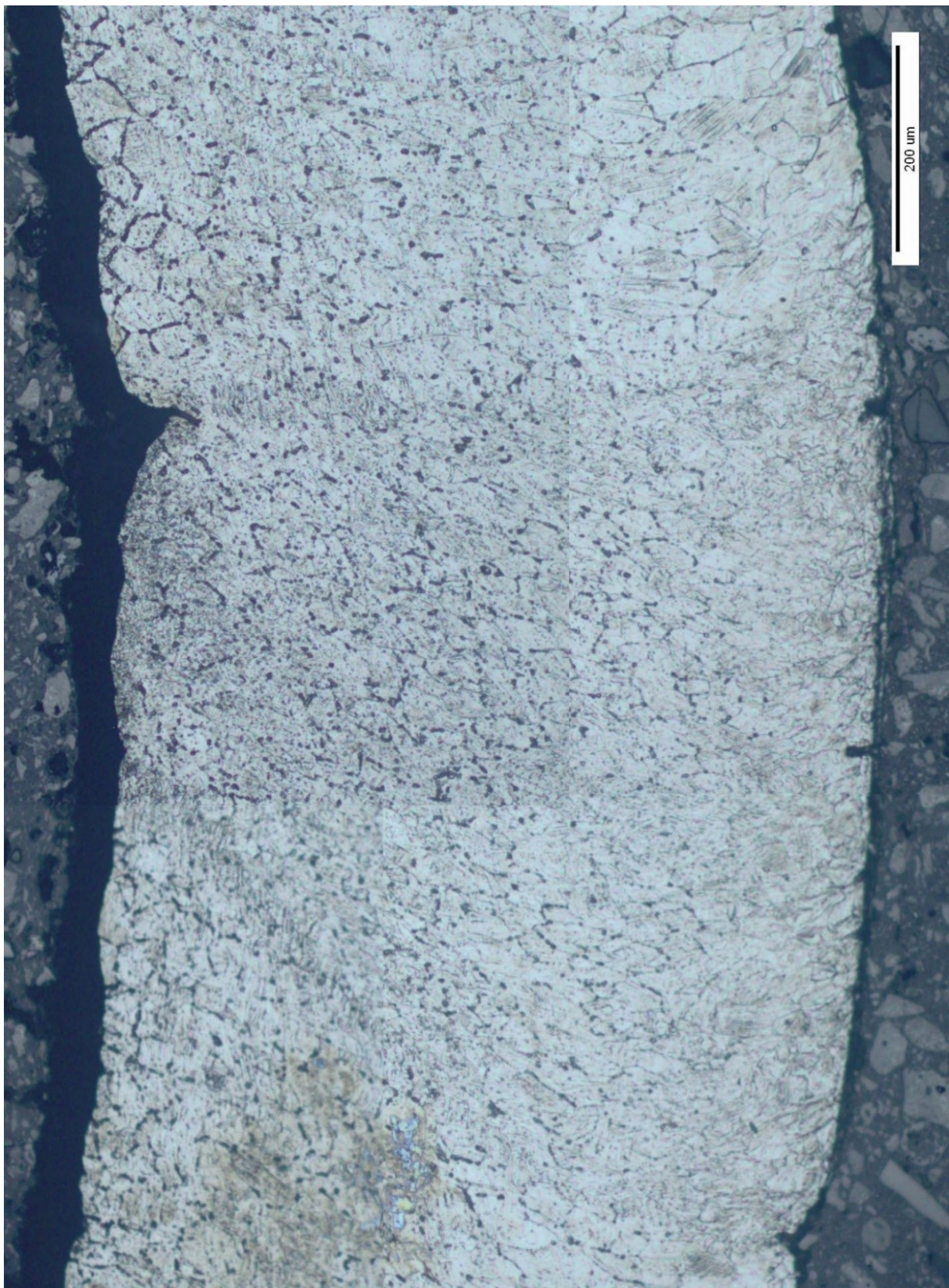
Slika 51. Mikrostruktura zavarenog spoja nakon rastvornog žarenja; v=0,6 m/min pri većem povećanju
