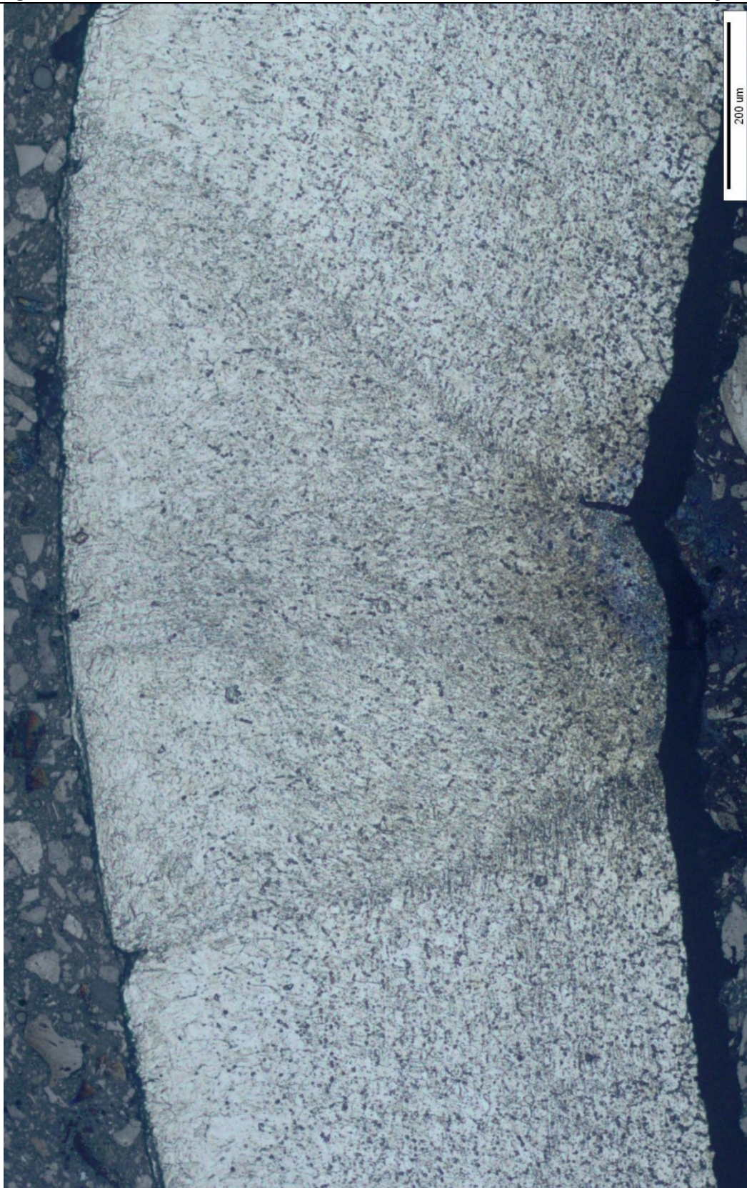
Slika 68. Mikrostruktura zavarenog spoja nakon rastvornog žarenja; v=1,20 m/min pri većem povećanju
