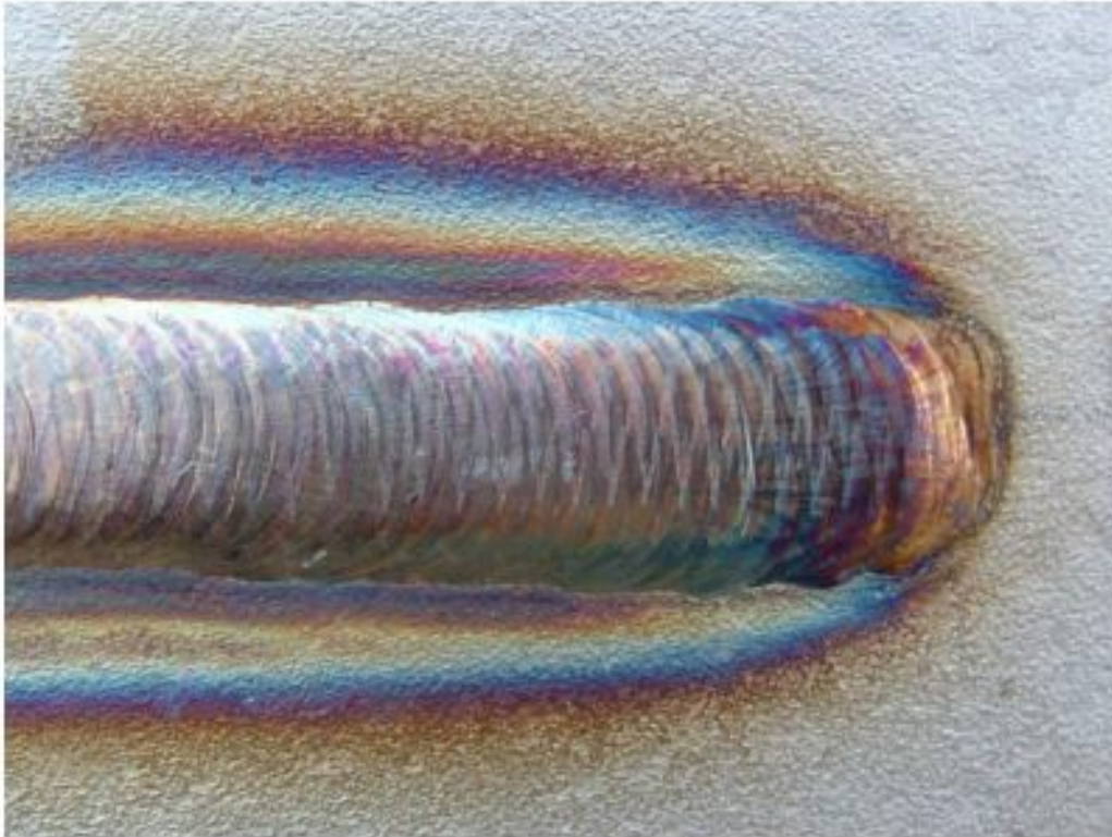
Slika 17. Obojenja površine nastala unosom topline postupkom zavarivanja [6]
