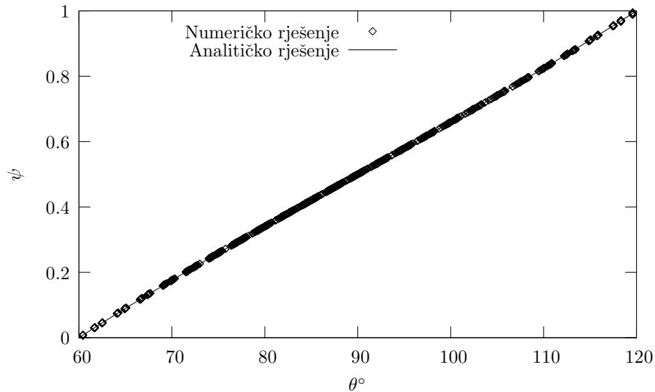
Slika 5.8: Rješenje osnosimetričnog difuzijskog transporta na površini sfere.
