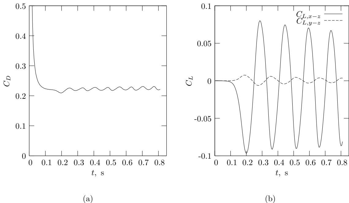
**Slika 7.17:** Koeficijenti otpora i uzgona za 3-D mjeđurić ekvivalentnog polumjera  $r_b = 1$  mm bez prisustva surfaktanta na slobodnoj površini.
