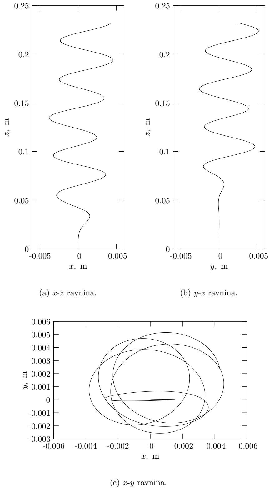
**Slika 7.20:** Putanja 3-D mjehurića polumjera  $r_b = 1 \text{ mm}$  sa surfaktantom na slobodnoj površini.
