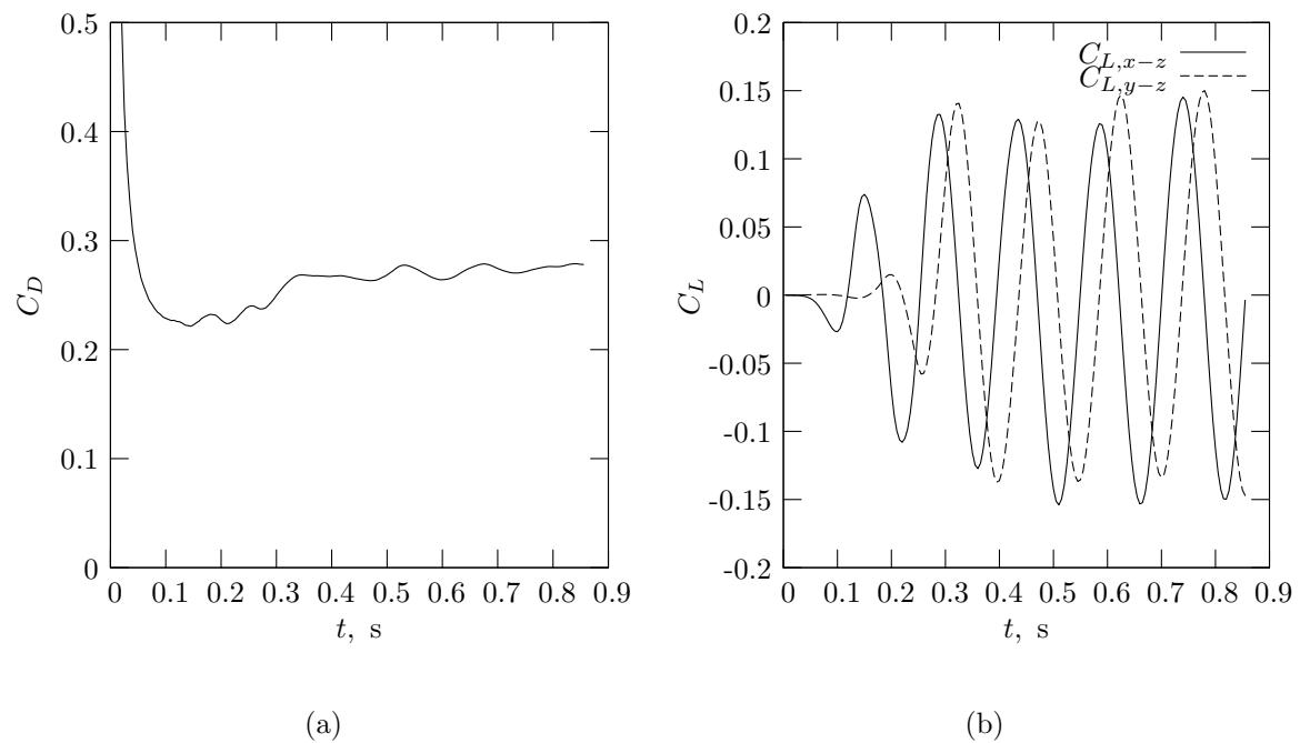
**Slika 7.22:** Koeficijent otpora  $C_D$  i uzgona  $C_L$  za 3-D mjeđurić polumjera  $r_b = 1$  mm sa surfaktantom na slobodnoj površini.
