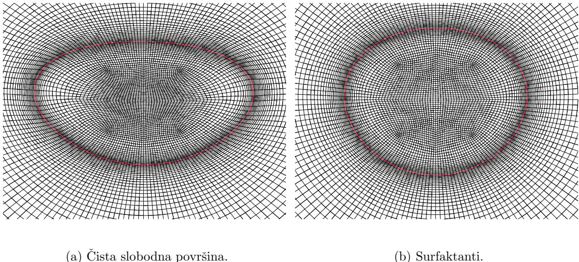
**Slika 7.14:** Deformirana mreža za 2-D mjehurić ekvivalentnog polumjera  $r_b = 0.75$  mm, sa i bez nazočnosti molekula surfaktanta na slobodnoj površini, u vremenskom trenutku  $t = 0.4$  s.
