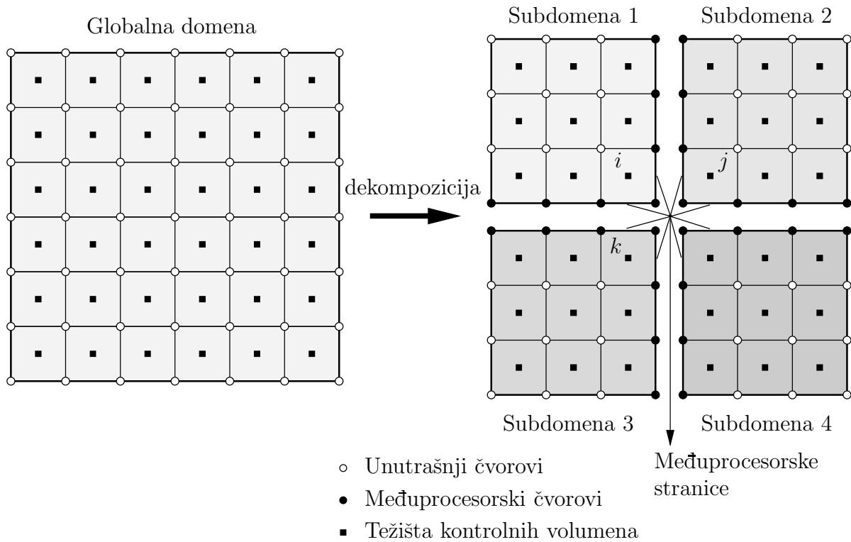
**Slika 3.9:** Dekompozicija domene za paralelni postupak rješavanja.
