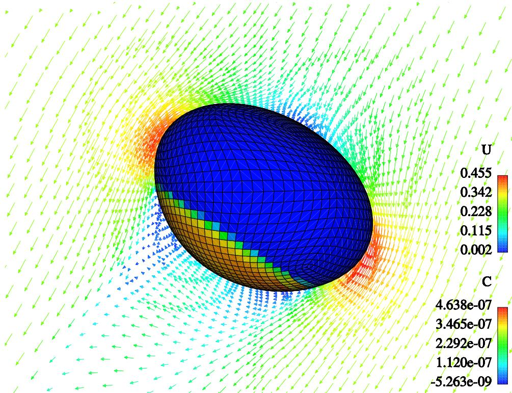
**Slika 7.23:** Vektori brzine u  $x-z$  ravnini za 3-D mjehurić sa surfaktantom na slobodnoj površini. Boje definiraju raspodjelu koncentracije surfaktanta ( $C$ ,  $\text{mol}/\text{m}^2$ ) na površini mjehurića.
