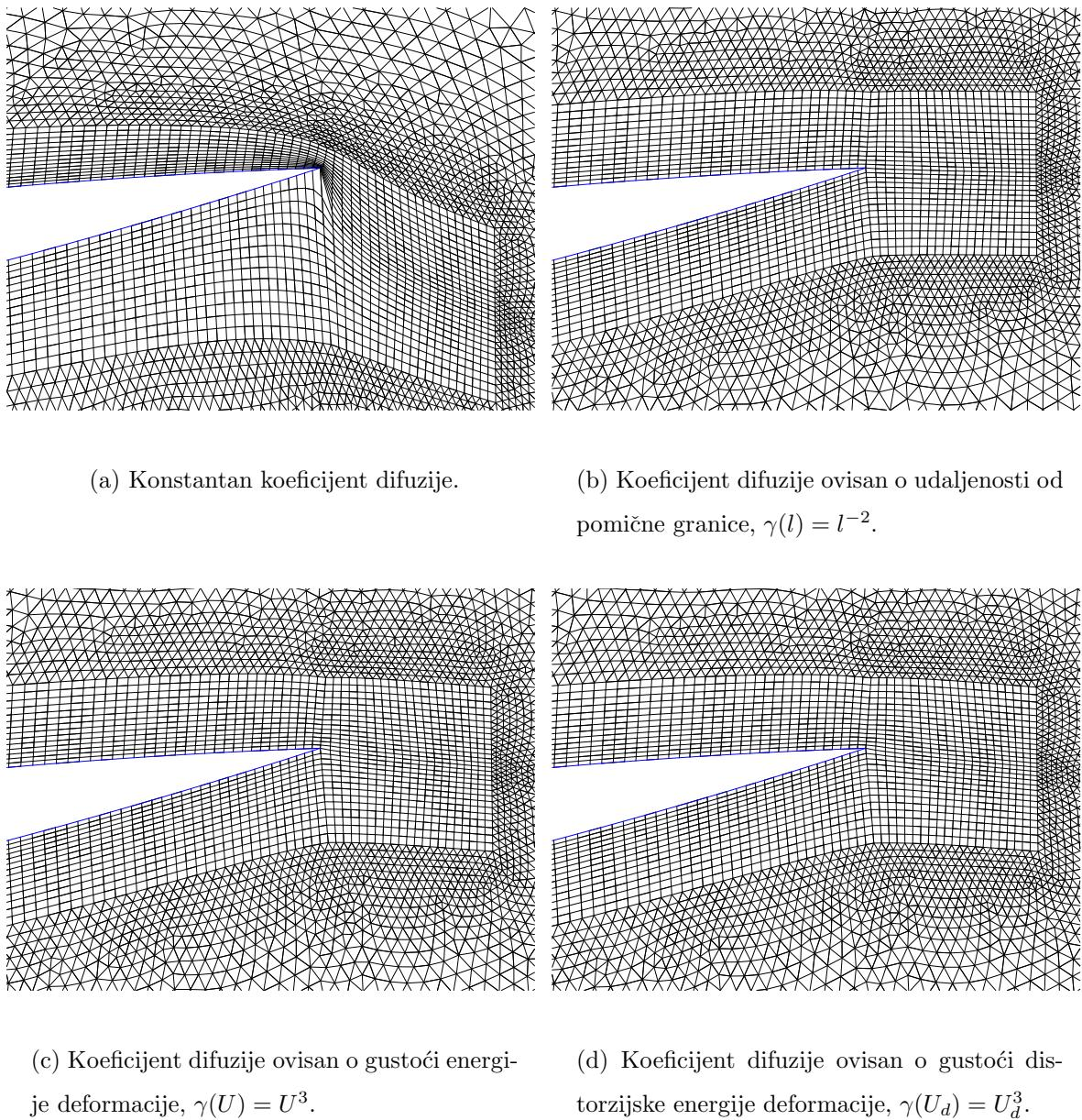
**Slika 4.18:** Pomaknuta mreža u području izlaznog brida NACA0012 profila u trenutku  $t = 0.5$  s za različite zakonitosti raspodjele koeficijenta difuzije u Laplaceovoj jednadžbi.
