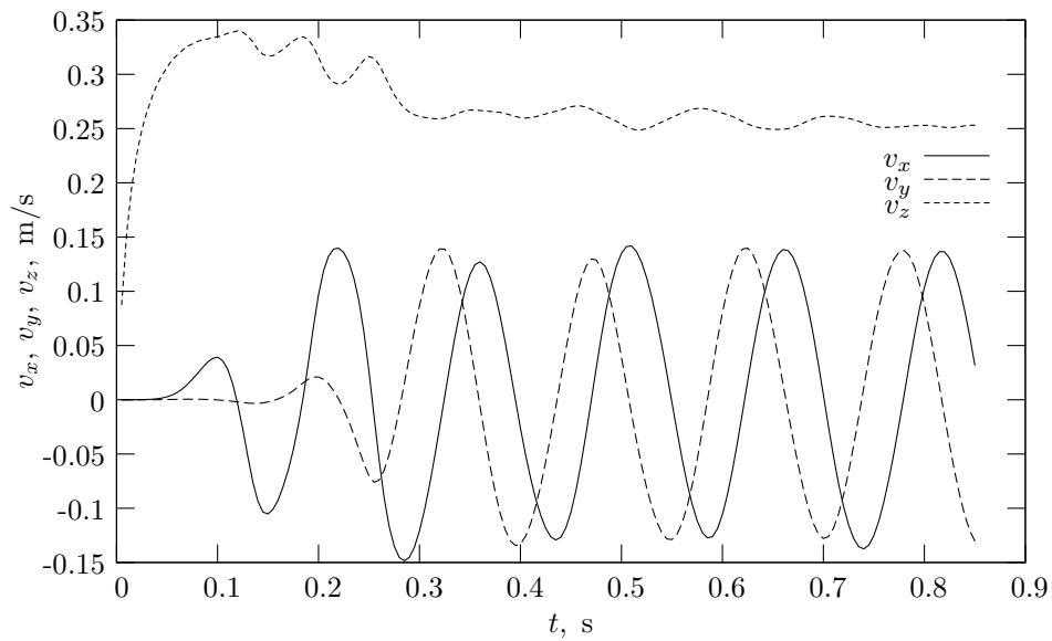
**Slika 7.21:** Brzina težišta 3-D mjeđurića polumjera  $r_b = 1$  mm sa surfaktantom na slobodnoj površini.
