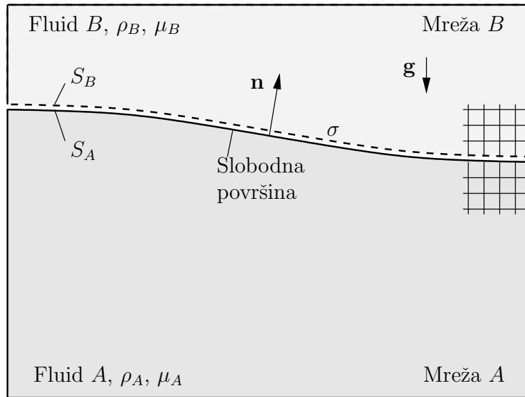
**Slika 6.1:** Definicija prostorne domene za numeričko modeliranje strujanje dvofaznog fluida sa slobodnom površinom primjenom pomicne mreže.
