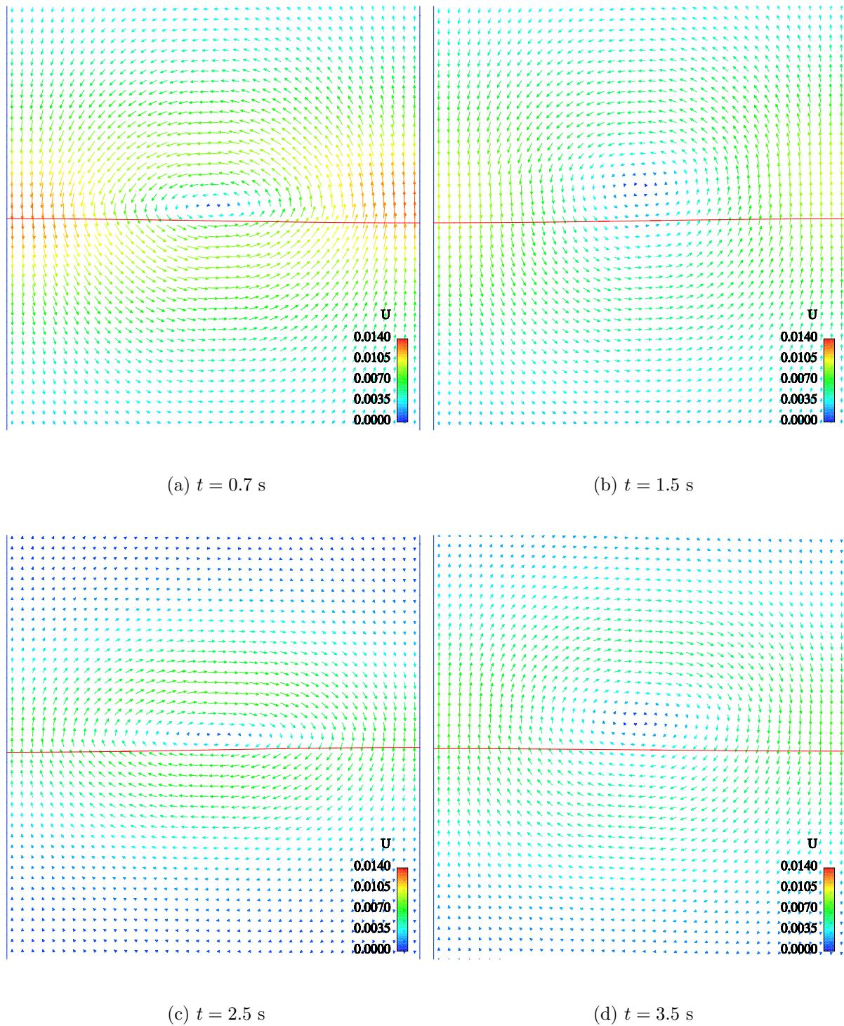
**Slika 7.9:** Vektori brzine kod oscilacije slobodne površine u 2-D spremniku za omjer gustoća fluida  $\rho_B/\rho_A = 0.1$ .
