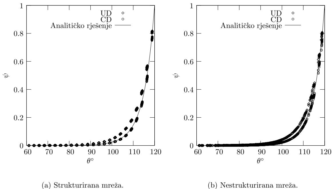
**Slika 5.11:** Rješenje osnosimetričnog konvekcijsko-difuzijskog transporta na površini sfere za  $\text{Pe} = 10$ .
