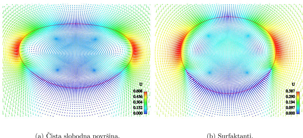
**Slika 7.13:** Вектори брзине за 2-D мјехурић еквивалентног пolumjera  $r_b = 0.75$  mm, sa i bez назоčности молекула surfaktanta на сlobodној површини, u vremenskom trenutku  $t = 0.4$  s.
