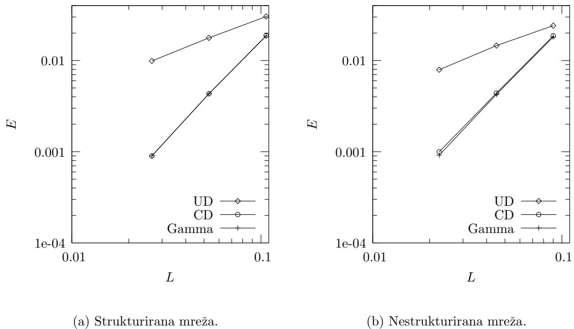
**Slika 5.12:** Pogreška rješenja osnosimetričnog konvekcijsko-difuzijskog transporta na površini sfere za  $\text{Pe} = 10$ .
