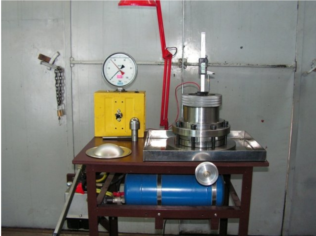
Slika 4.1: Naprava za klasično i modificirano hidraulično udublivanje
