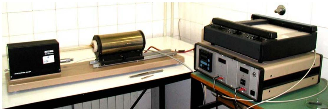
Slika 8.2 Izgled elektroničkog dilatometra Netzschi 402 EP
