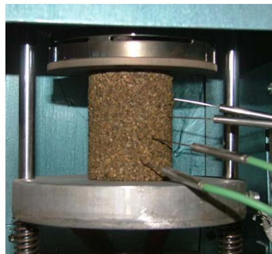
Slika 6.4 Mehanizam za držanje uzorka
