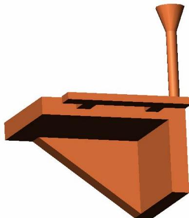
Slika 4.3 Eksperimentalni odljevak prema AFS [10]
