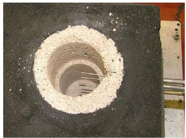
Slika 7.5 Unutrašnjost kalupa s mjernim osjetilima bez uzorka
