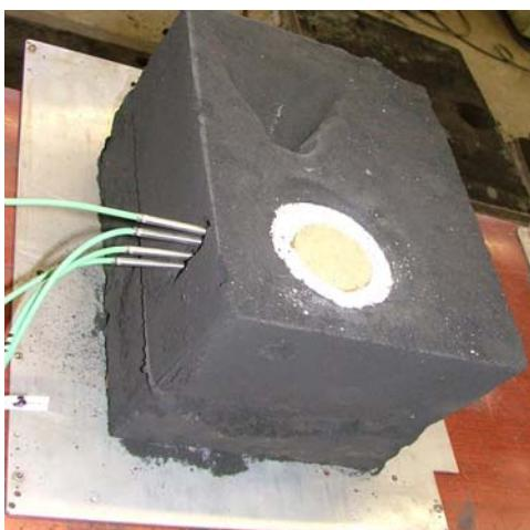
Slika 7.4 Kalup s mjernim osjetilima i uzorkom
