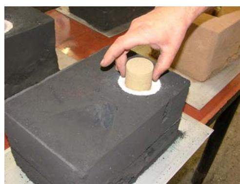
Slika 7.2 Umetanje uzorka u kalup
