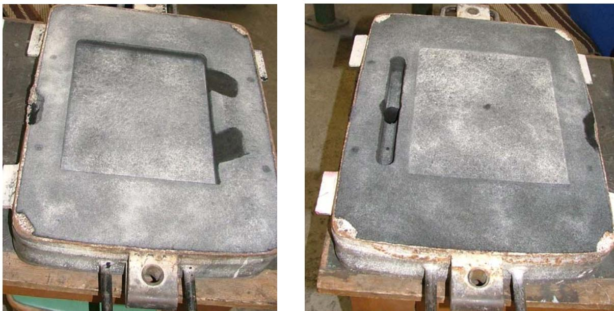
Slika 9.8 Kalup za lijevanje ploća za klasifikaciju ljevačkih pjeskova
