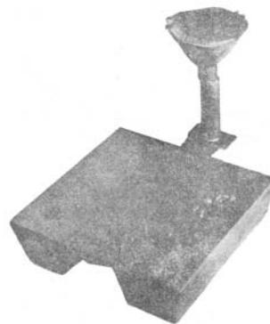
Slika 4.36 Test odljevak prema Kilshaw-u [29]
