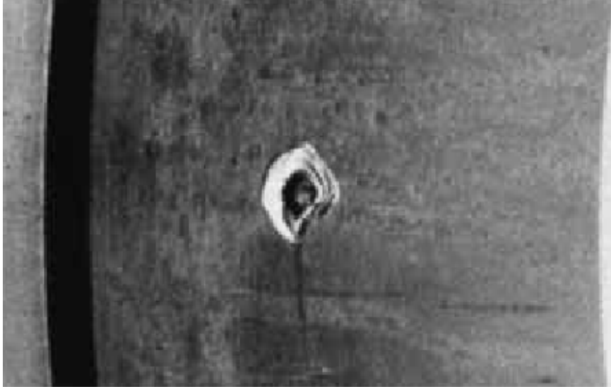
Slika 4.11 Točkasto oštećenje ležaja nastalo prolaskom električne struje [112]
