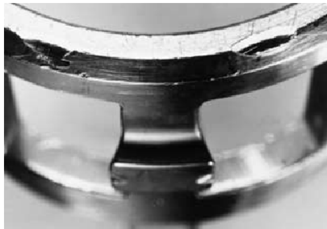
Slika 4.10 Metalni kavez s udubljenjima [110]
