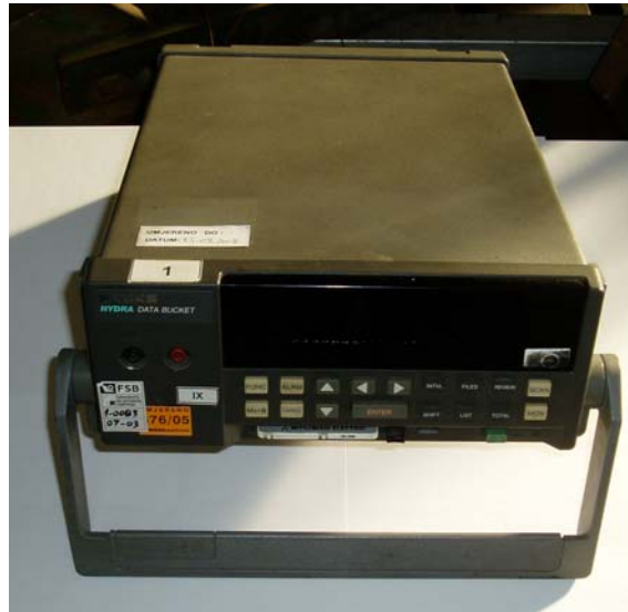
Slika 5.5 Uređaj za pohranjivanje podataka vrijednosti temperature „Fluke – Hydra” s ispitivanog ležaja SKF 6206
