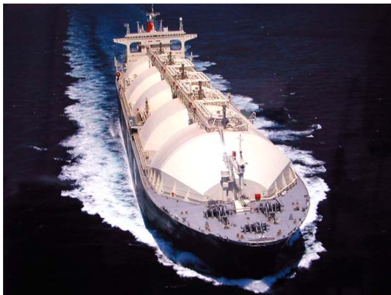
Slika 2-3 LNG brod, 145000 m 3 , Moss-Type spremnici
