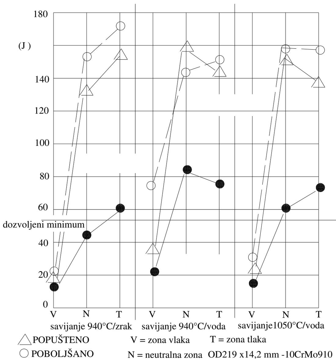
**Slika 5.8.** Žilavost u zonama luka savijene cijevi  $\phi 219 \times 14,2$   $r = 660 \text{ mm}$ , 10CrMo910, nakon toplinske obrade: popušteno 750 °C/30 min/zrak i poboljšano 940 °C/5 min/zrak + 750 °C/30 min/zrak [1]
