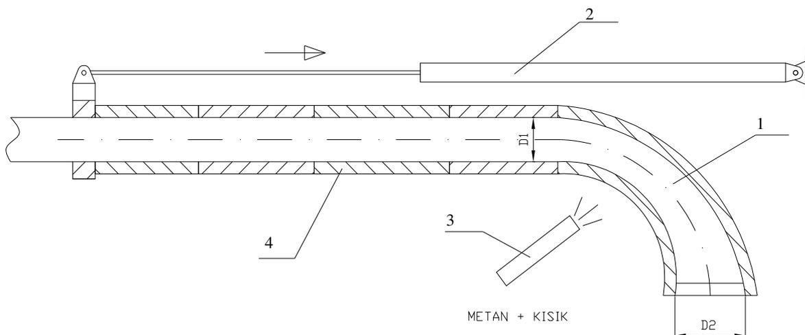
**Slika 3.3.** Princip izrade cijevnog luka tiskanjem preko trna u toplom stanju.
