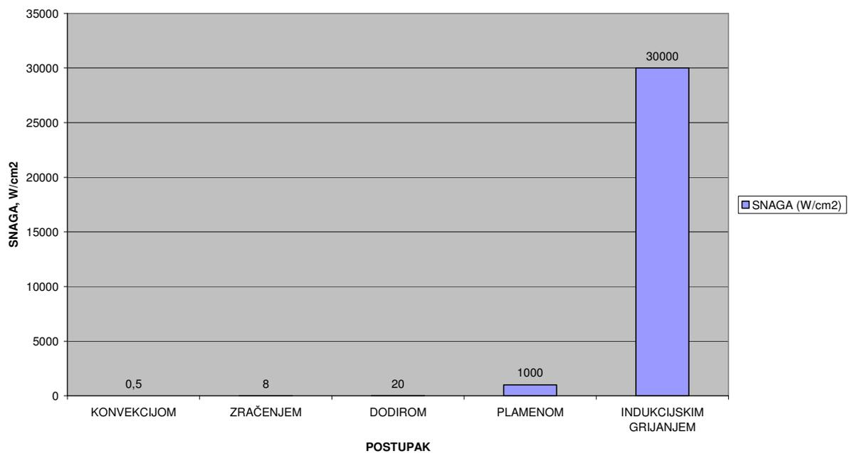
**Slika 3.12.** Snaga koja se može prenijeti postupcima grijanja [5]. Konvekcijom, zračenjem, dodirom, plamenom i indukcijskim postupkom grijanja
