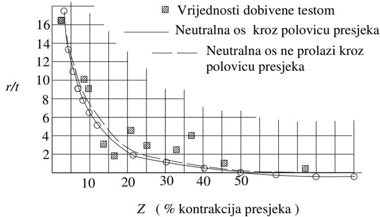
**Slika 2.6.** Odnos minimalnog radijusa savijanja i debljine lima dobiven analitički [4]
