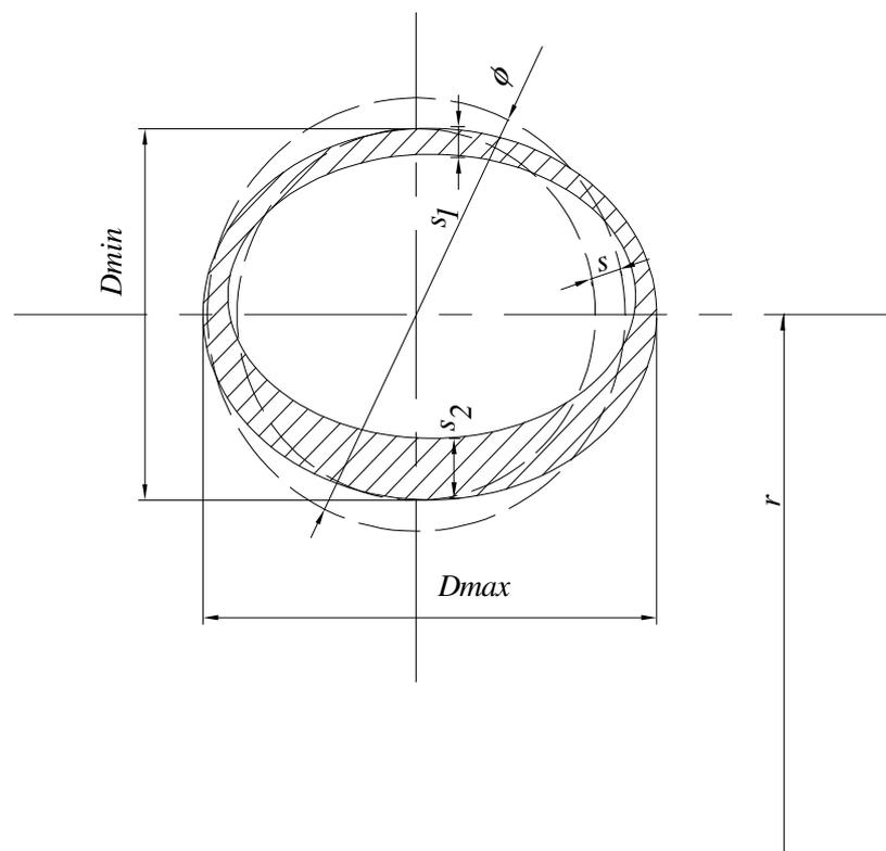
**Slika 5.7.** Prikaz karakterističnih dimenzija presjeka cijevnog luka
