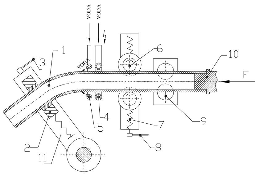
**Slika 3.8.** Funkcionalna shema savijanja kontinuirano inkrementalnim postupkom
