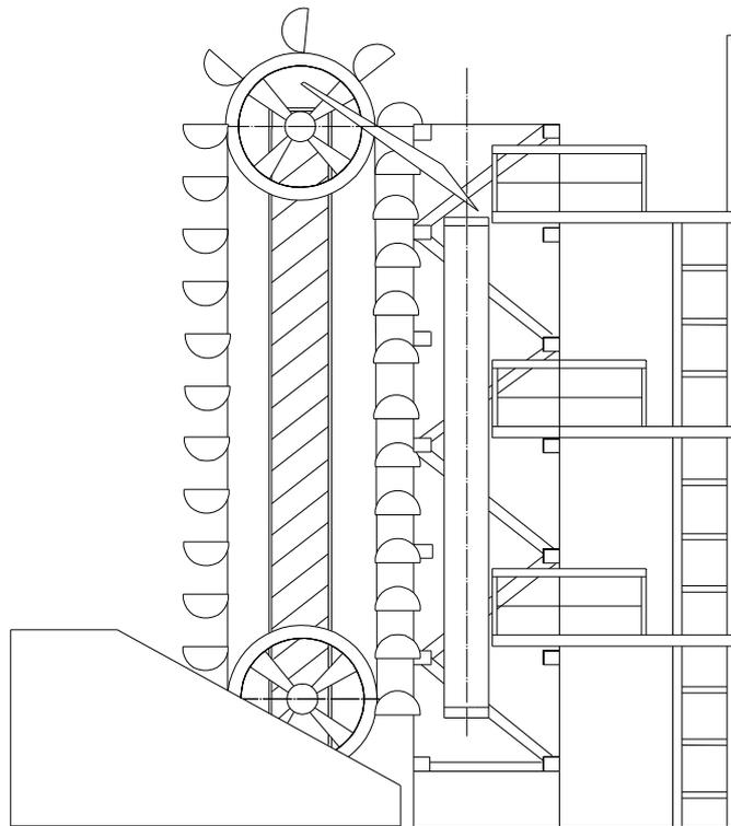
**Slika 3.4.** *Postrojenje za punjenje cijevi pijeskom – elevator [19]*
