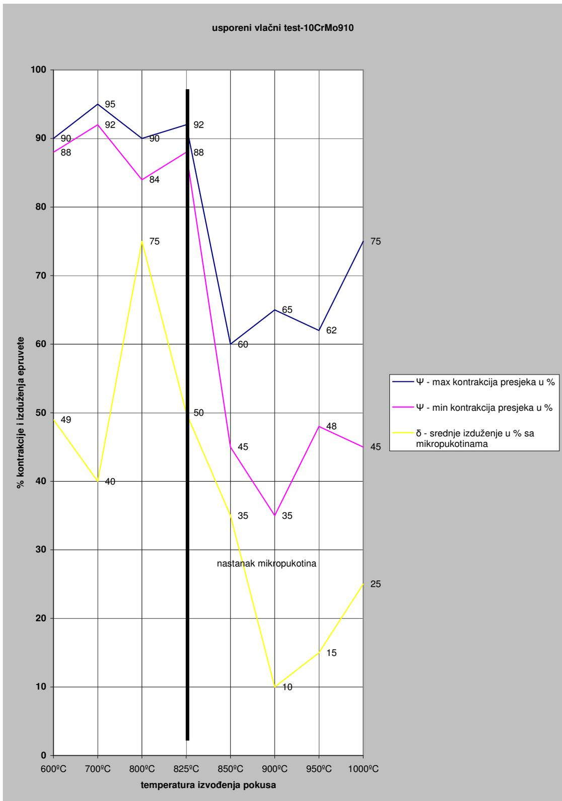
**Slika 5.10.** Usporeni vlačni test na toplo za materijal 10CrMo910 [1]
