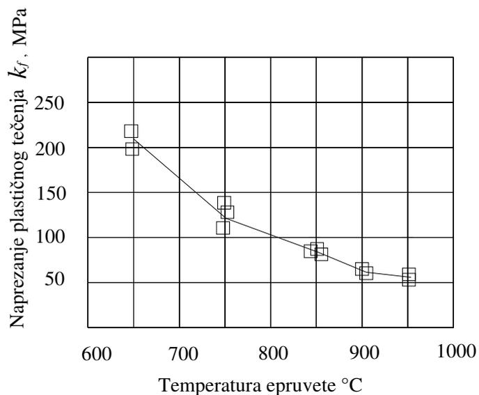
**Slika 5.3.** Vlačni test – naprezanje plastičnog tečenja prema Siebel-Schwaigerer-u
