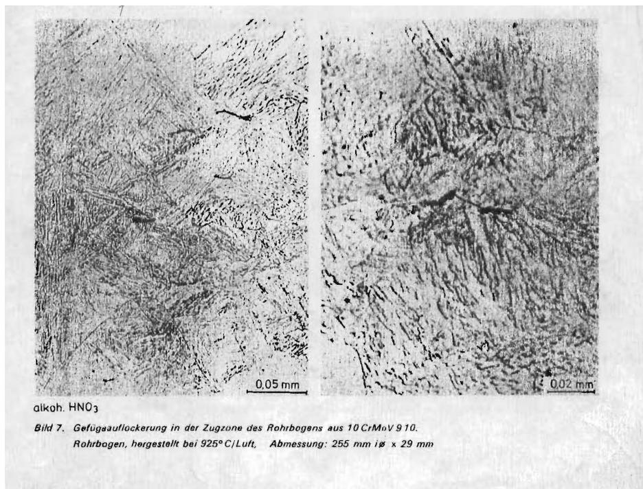
**Slika 5.9.** Mikropukotine na vlačnom dijelu cijevnog luka iz materijala 10CrMo910 [1]
