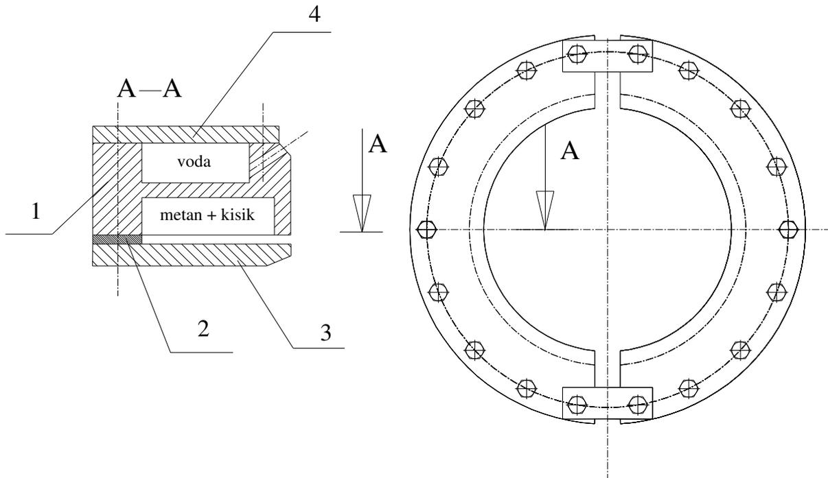
**Slika 6.6.** Plinski, vodom hlađeni grijač cijevi za debljine stijenke cijevi do 28 mm.
