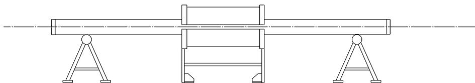
**Slika 3.5.** *Peć za grijanje cijevi [19]*
