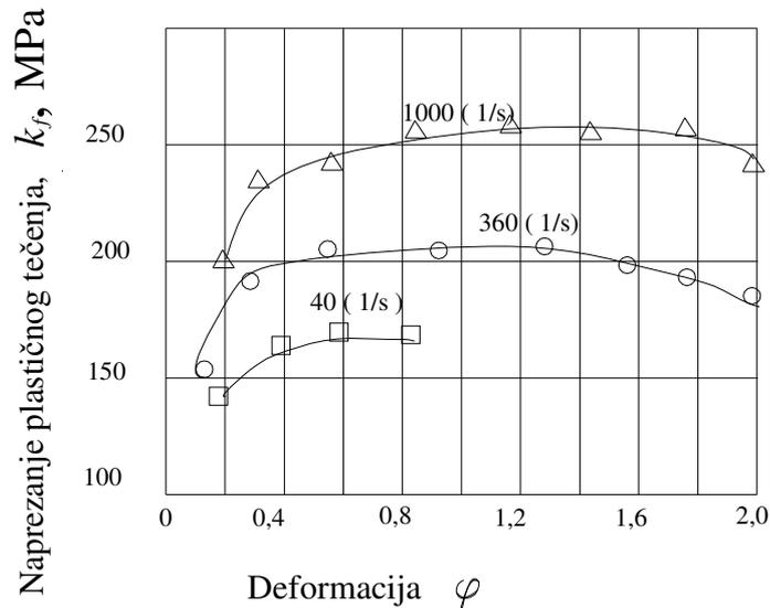
**Slika 2.1.** Utjecaj logaritamskog stupnja deformacije i brzine deformacije na napreznje plastičnog tečenja za materijal C15 pri temperaturi 1100 °C [ 10 ]
