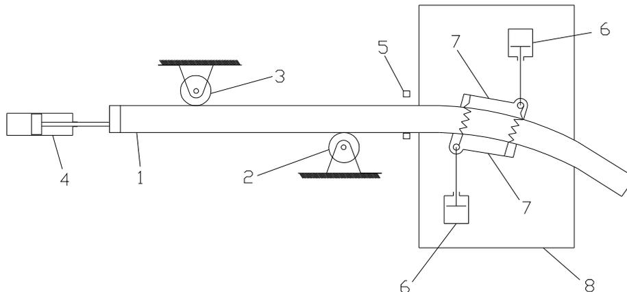
**Slika 3.7.** *Mehanizam za savijanje cijevi inkrementalnim postupkom prema Nakamura Terisige. ( 1 ) tijelo stroja, ( 4 ) hidraulični suport, ( 2 i 3 ) bočni valjci, ( 5 ) indukcijski grijač, ( 6 ) momentni hidraulični cilindri i (7) polužje*
