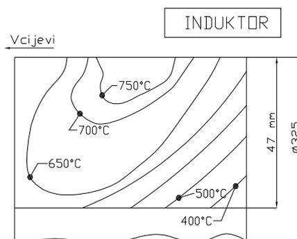
$V_{cijevi} = 40 \text{ [mm/min]}$
