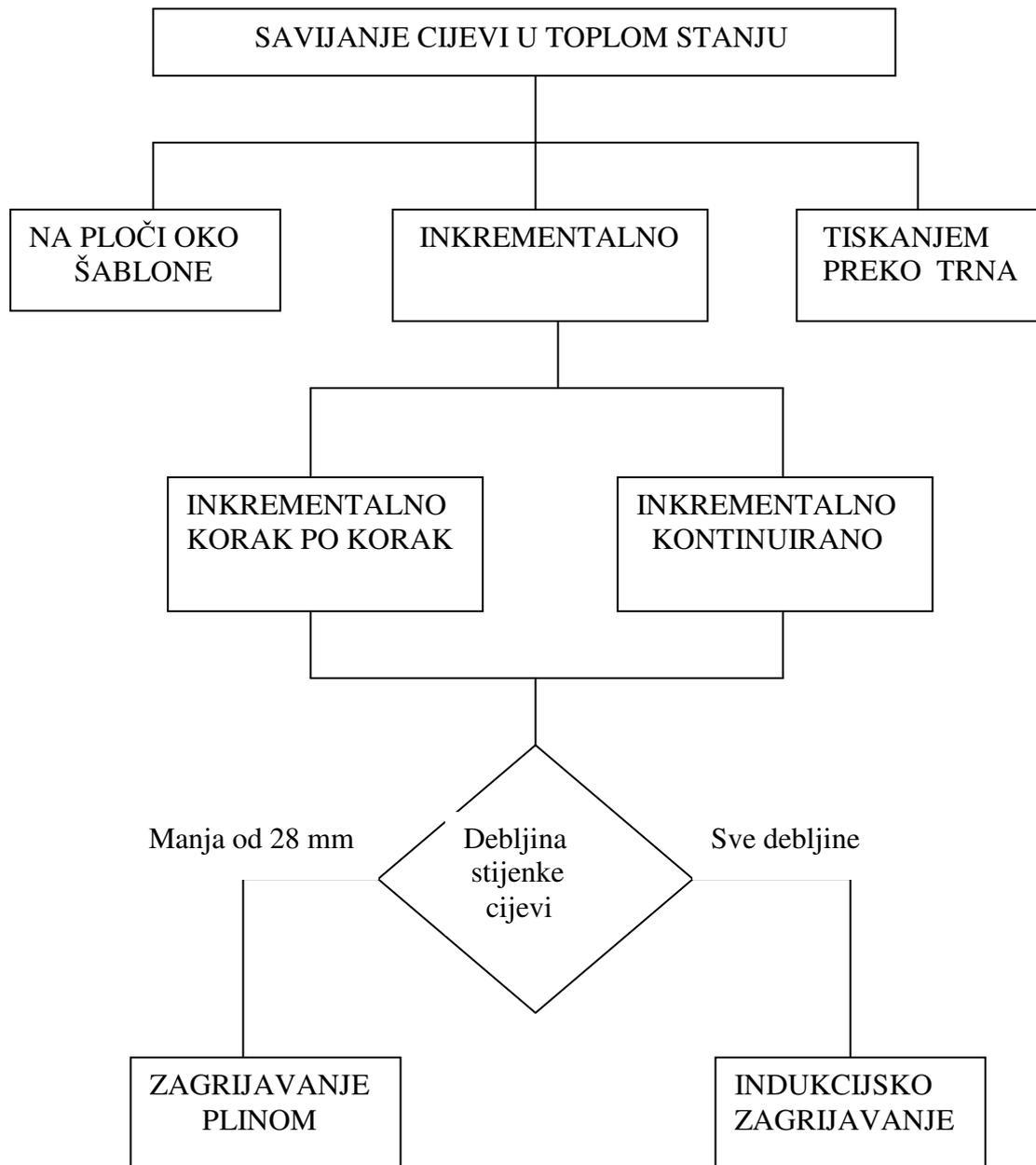
**Slika 3.1.** Podjela postupaka savijanja cijevi u toplom stanju
